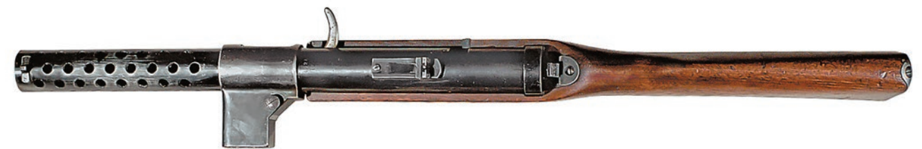
Немецкий пистолет-пулемёт Bergmann MP 18 модернизированный (MP 18.IV) системы Х. Шмайссера. Отличался от образца MP 18.I только устройством магазина и его горловины. Маркировка MP18.IV на оружии не ставилась и нашла отражение только в технической документации. Вместимость коробчатого магазина 20 или 32 патрона
