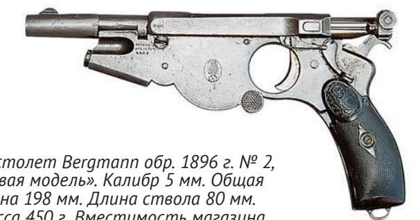
Пистолет Bergmann обр. 1896 г. № 2, «старая модель», ранний выпуск. Калибр 5 мм. Принцип работы автоматики – свободный затвор. Общая длина 175 мм. Длина ствола 89 мм. Масса без патронов 470 г. Вместимость магазина 5 патронов. Заряжание пачечное. Пачку можно было оставить внутри магазина или вынуть через прорезь крышки, потянув за кольцо, которое оставалось снаружи после того, как крышка магазина закрывалась. Однако без пачки в магазине патроны часто перекашивались при подаче
