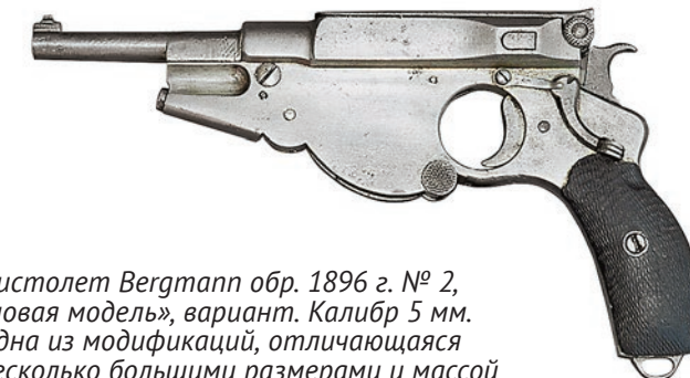
Пистолет Bergmann обр. 1896 г. № 2, «новая модель». Калибр 5 мм. Общая длина 198 мм. Длина ствола 80 мм. Масса 450 г. Вместимость магазина 5 патронов. Складной спусковой крючок заменён на обычный
