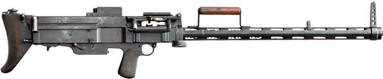
Ручной пулемёт Bergmann MG 15 системы Л. и Х. Шмайссера. Калибр 7,92 мм. Принцип автоматики — короткий ход ствола. Ударный механизм куркового типа. Стрельба из пулемёта велась с открытого затвора
