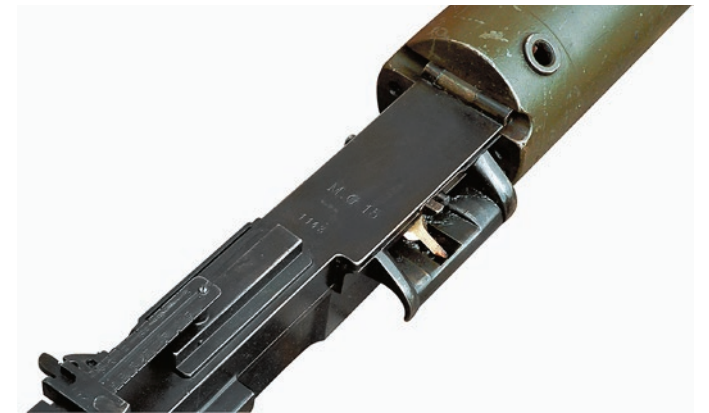
Станковый пулемёт Bergmann MG 15 системы Л. Шмайссера (модификация пулемёта MG 10 того же конструктора). Отличался от базовой модели MG 10, имевшей только станок-треногу массой 20 кг, возможностью установки также и на станке-салазках пулемёта Maxim MG 08. Использовался в основном в кавалерийских пулемётных ротах германской армии. Калибр 7,92 мм. Принцип автоматики — короткий ход ствола. Общая длина 1080 мм. Длина ствола 725 мм. Темп стрельбы 600 выстр./мин. Боевая скорострельность 300 выстр./мин. Прицельная дальность стрельбы 2 000 м. Питание ленточное — 250 патронов. Масса тела пулемёта 16,3 кг
