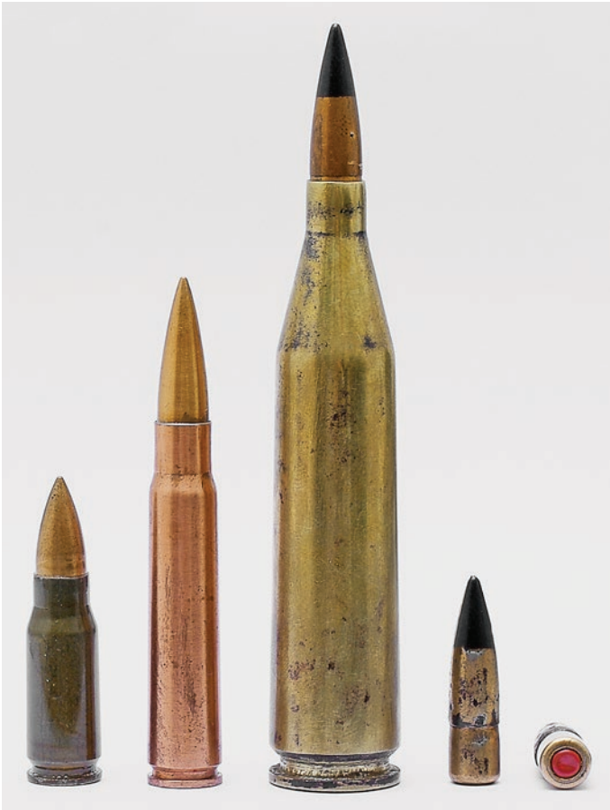
7,92-мм патроны германской армии, 7,92x33 (Pist. Patr. 43), 7,92x57 (Mauser), 7,92x94 (Patr. 318), пуля SmKH-Rs-L'spur и её донная часть (под красным целлюлоидным колпачком расположен трассер, за которым в углублении сердечника размещено ОВ). При разряжении патронов по прошествии 70 лет с момента производства сразу ощущаешь лёгкое пощипывание в носу (хлорацетофенон за это время просочился через трассер)
