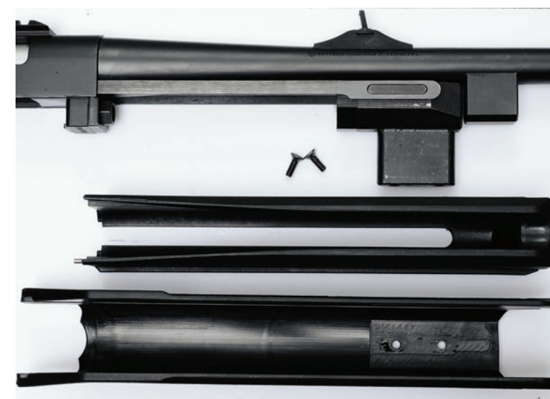
Для отделения цевья у модели Arttech Prima XP необходимо отвернуть два винта комплектным ключом
