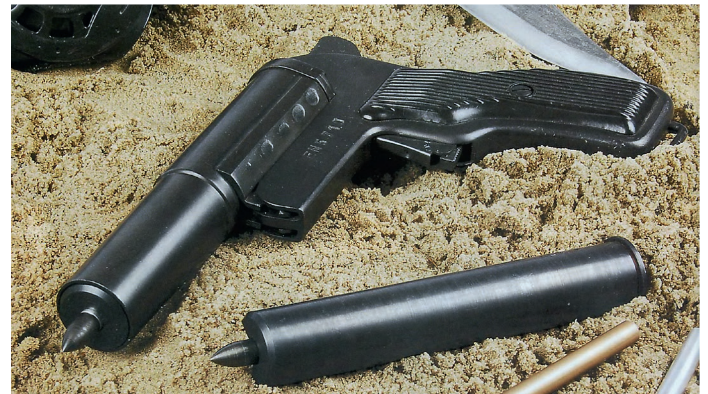
Югославский боеприпас SSU был предназначен для использования с 26-мм сигнальным пистолетом
