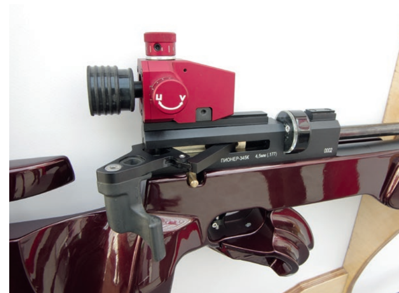
«Пионер» образца 2017 г. с отдельным элементом для досылания пули в канал ствола, который не связан с рычагом перезарядки. На этой выставочной винтовке ещё стоит индекс «145», который в серии поменяется на «245»
