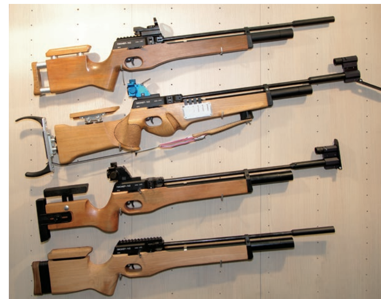
Биатлонные винтовки «Пионер-145» в различных исполнениях (2016 г.). На двух нижних с правой стороны ствольной коробки хорошо просматривается рычаг для перезарядки
