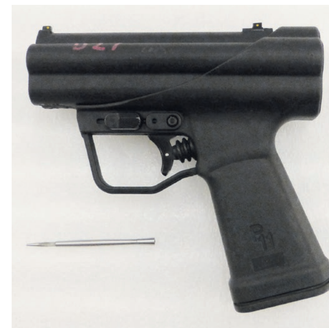
Общий вид и схема из патента на немецкой подводный пистолет P11, разработанный компанией Heckler & Koch
