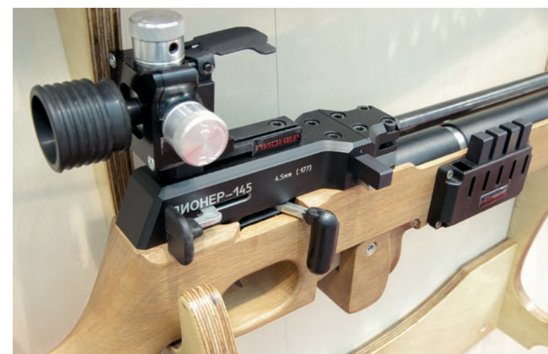
«Пионер» образца 2017 г. с отдельным элементом для досылания пули в канал ствола, который не связан с рычагом перезарядки. На этой выставочной винтовке ещё стоит индекс «145», который в серии поменяется на «245»
