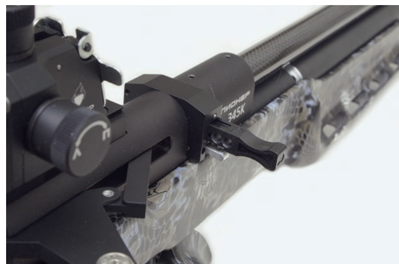
Ствольная коробка «Пионеров-345К», рассчитанных на использование пятиместных магазинов кассетного типа, оснащается отдельным узлом, который можно назвать магазинной коробкой. Чтобы извлечь из неё кассету, нужно отжать небольшой рычажок вниз, предварительно отведя затвор в заднее положение
