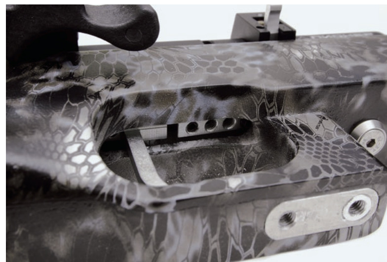
Шептало (второе шептало) имеет 4 резьбовых отверстия для регулировочных винтов, позволяющие настроить усилие спуска по своему желанию. На фотографии один винт вставлен в крайнее переднее отверстие, частично прикрытое ложей
