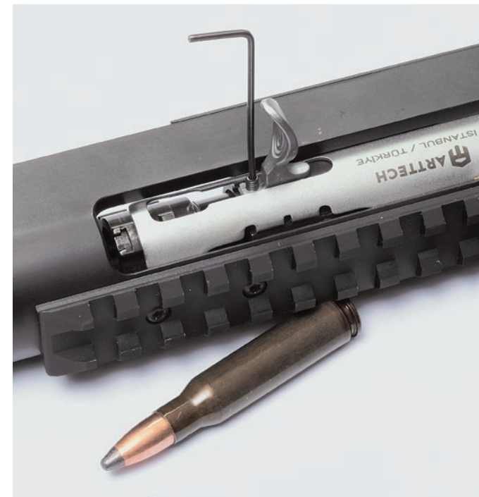
Для извлечения затвора из затворной коробки необходимо отделить его рукоятку. Для этого комплектным ключом выворачивается стопорный винт, после чего рукоятка сдвигается вперёд и вынимается
