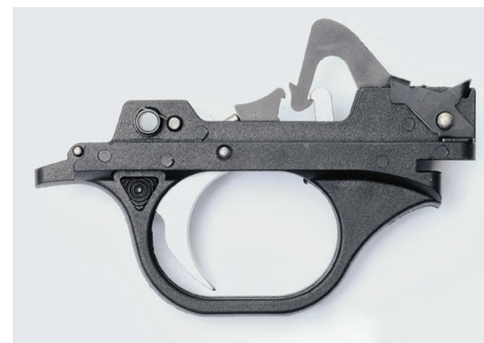
УСМ для карабинов Arttech Prima собран на отдельном основании из полиамида и фиксируется в спусковой коробке поперечным штифтом с пружинным стопором. Отверстие под него видно над кнопкой предохранителя
