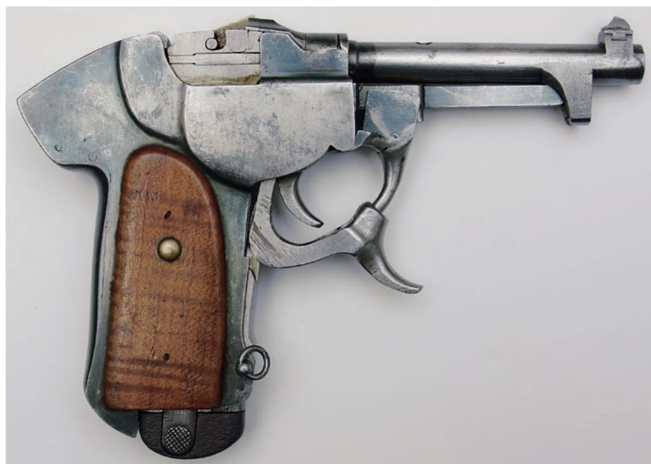
Общий вид 7,65-мм пистолета Ознобищева. Фото ВИМАИВ и ВС. На фото справа вверху затвор пистолета в заднем положении. Мушка пистолета имела V-образный профиль
