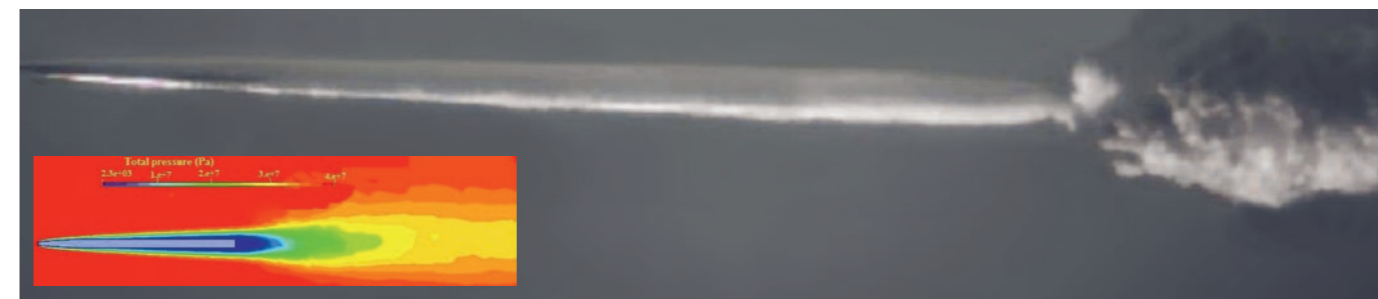
Кавитационная полость при реальном выстреле, зафиксированная методом высокоскоростной съёмки и диаграмма давления среды при явлении кавитации
