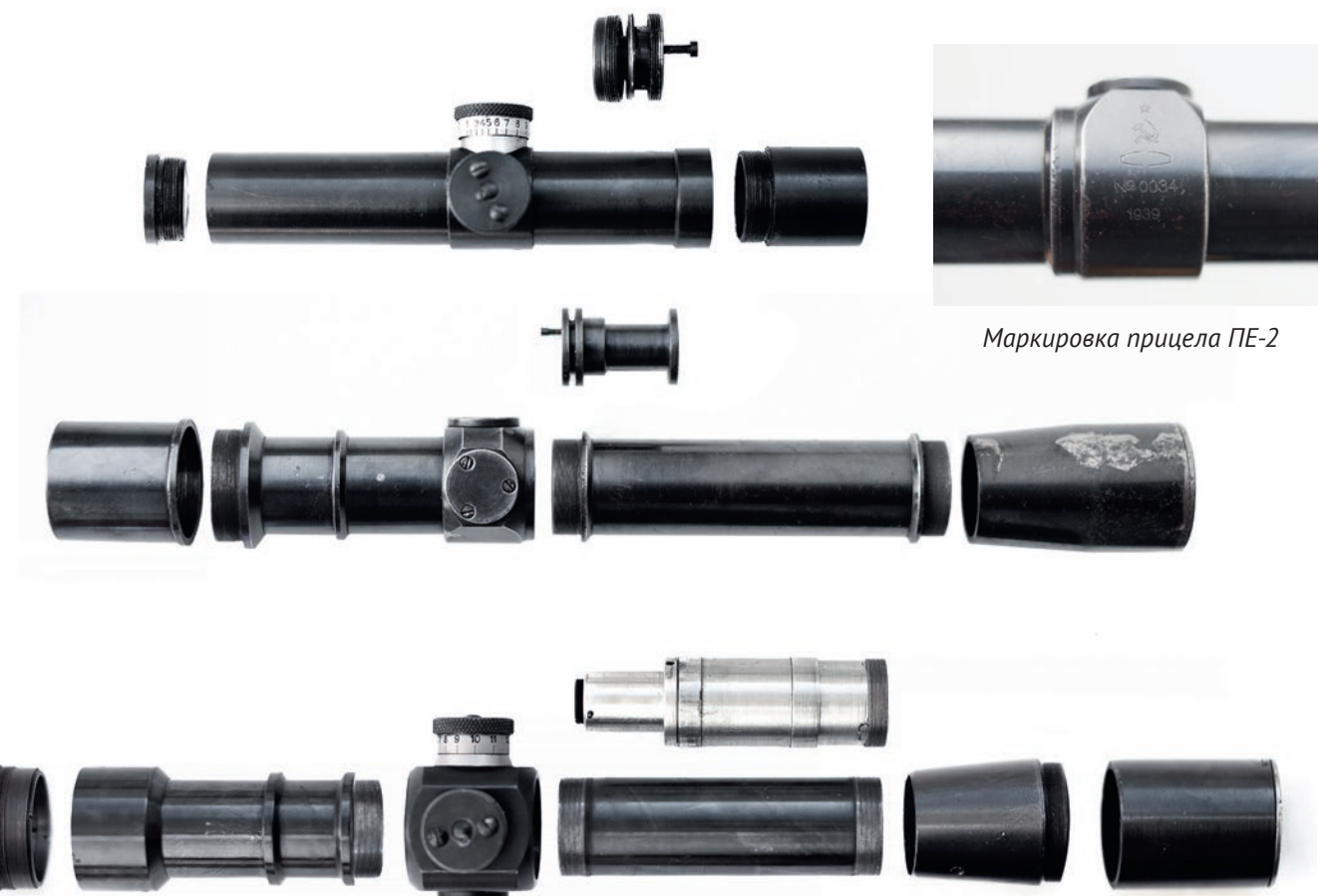
Сравнение конструкции прицелов ПУ, ПЕ-2, и ПЕ (сверху вниз)
