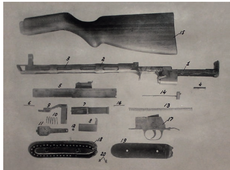
Пистолет-пулемёт конструкции Московского (макет), вид справа и его полная разборка
