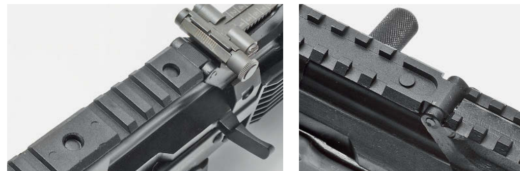
В настоящее время в продаже встречаются «Вепри» с планками «пикатини», изготовленными из полиамида (слева) или алюминиевого сплава
