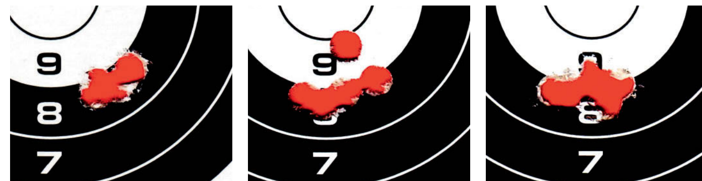
Некоторые результаты стрельбы на 5 м (винтовка Gamo CF): а – пули Vostok; б – DS 0,28; в-цилиндрикоконические пули ранней партии
