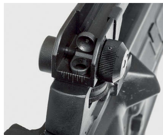
Диоптрический прицел на рукоятке для переноски; барабанчик, установленный вертикально (верхний), служит для регулировки боя по горизонтали; барабанчик, установленный горизонтально (нижний) – для ввода углов прицеливания (установки дальности стрельбы)
