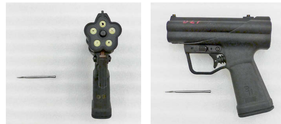
Бесшумный подводный пистолет HK P11, вид спереди. Хорошо видны пробитые пулями-стрелами мембраны, закрывающие дульные срезы стволов. Ниже показана стреловидная пуля для применения под водой
