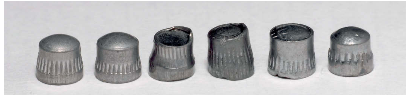
Колпачковые пули, которые появились на рынке недавно или всё ещё присутствуют на нём, слева направо: DS 0,28, DS 0,4, «Диаболо М 0,28», «Диаболо М 0,4», «Дельта», «Диаболо-1» NN. У обоих ижевских «колпачков» хорошо видны косые кромки «юбок», а у лёгкого – ещё и большой козырёк в головной части. (Фото С. Гришина)
