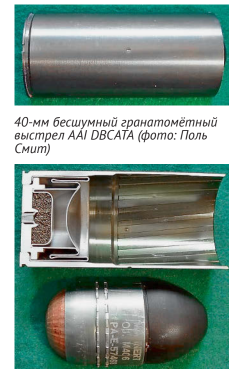
40-мм бесшумный гранатомётный выстрел AAI DBCATA. Гильза показана в разрезе, внутри видны сложенный «гармошкой» толкатель из тонкой листовой стали и готовые нарезы для гранаты. (фото: Поль Смит)
