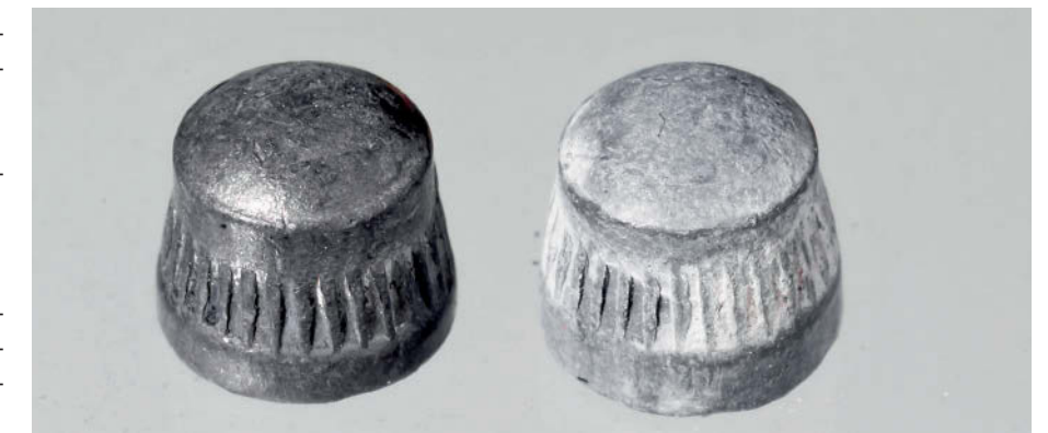
Самые старые участники экспериментов – климовская «Диаболо-1» (слева) и пуля Vostok. Белый налёт – результат окисления свинца в течение многих лет хранения. (Фото С. Гришина)
