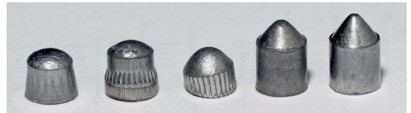
Пули, приобретённые в начале 2000-х годов, слева направо: «колпачок» КЗОРС, «Диаболо-1» (ТП-Артур), ПЗ-1, цилиндрикоконические пули ранней и поздней партий, соответственно. (Фото С. Гришина)
