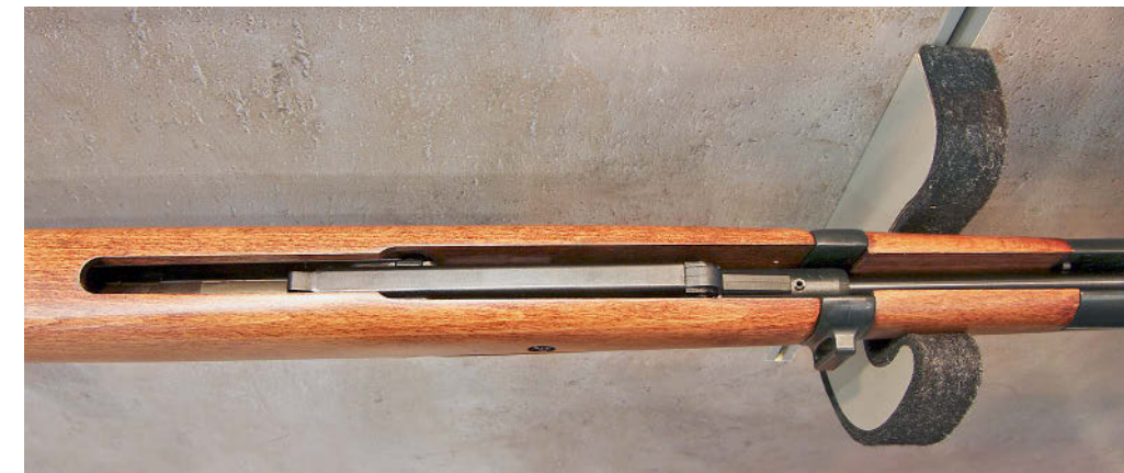
Элементы подствольного механизма взвода поршня у K98, за исключением конца рычага, полностью скрыты в длинной ложе
