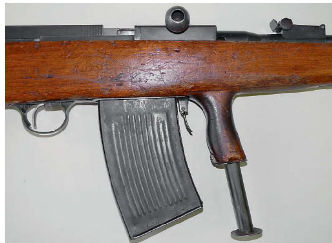
Автомат Федорова модели 1919 года с моносошкой, встроенной в переднюю рукоятку для удержания оружия. Фото ВИМАИВиВС
