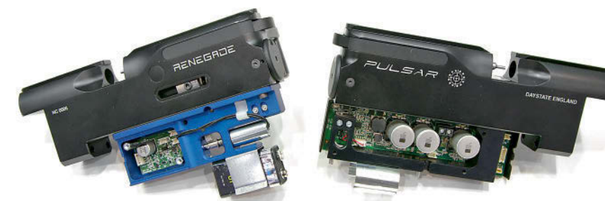
Ствольные коробки с бортовыми компьютерами двух буллпанов компании Daystate: справа плоская электроника, слева электроника поменьше и хорошо видимый соленоид, взаимодействующий с шепталом ударника
