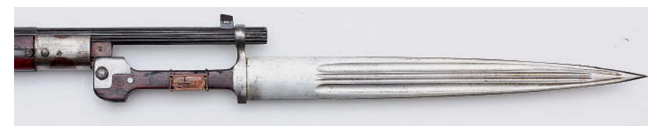
Дульная часть 7,62-мм автоматической винтовки Фёдорова 1913 года с установленным штыком-кинжалом. Фото ВИМАИВиВС
