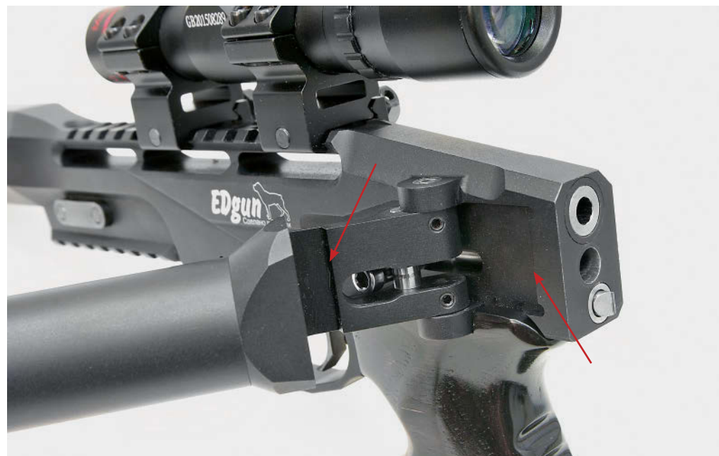
Вид на заднюю часть ствольной коробки «Лешего». Между стволом и подпружиненной защёлкой виден канал для ударника, который взводится штифтом, расположенным рядом с шарниром приклада. Красными стрелками показаны два упора, обеспечивающие запираение ствола
