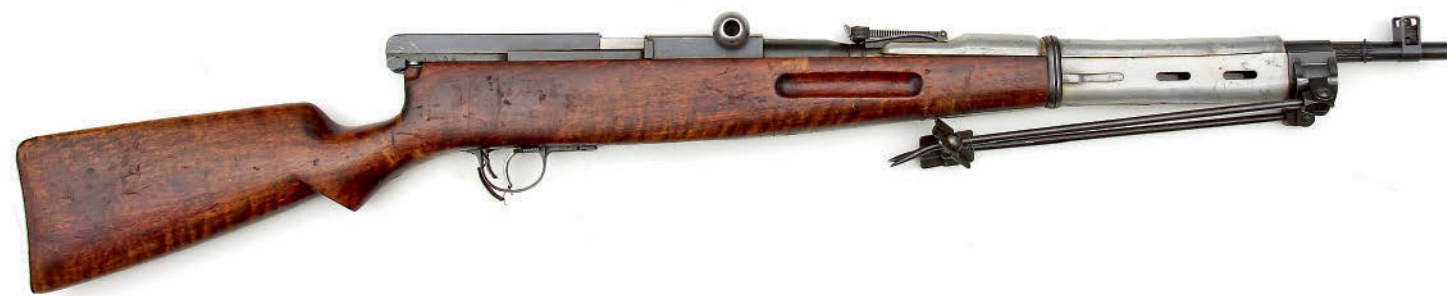
Автомат Федорова модели 1919 года с алюминиевыми наконечником ложи и ствольной накладкой, а также лёгкими сошками. Фото ВИМАИВиВС
