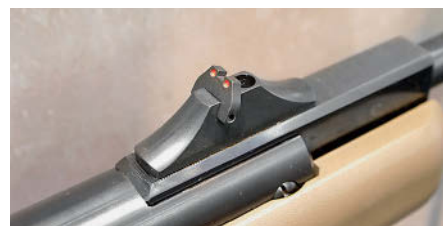
Открытый прицел охотничьего типа на винтовке Diana AM03. Переместить целик по горизонтали можно только с помощью миниатюрного инструмента
