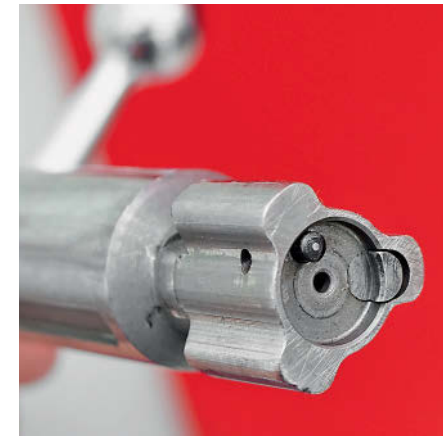
Остов затвора карабина «Егерь» с тремя боевыми выступами, выбрасывателем, отражателем гильзы, чашечкой и отверстием для выхода бойка
