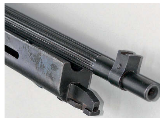
Экспериментальный вариант выступа на наконечнике ложи для крепления штыка по типу винтовки Маузер обр. 1898 г.
