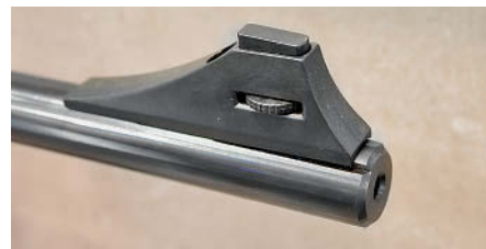
При приведении к нормальному бою винтовок AR8 и AM03 вертикальные поправки вводятся перемещением мушки вверх-вниз с помощью маховичка в её основании
