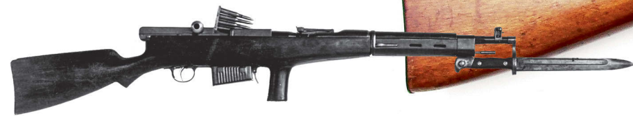
6,5-мм автомат Федорова модели 1919 года с магазином на 10 патронов и штыком. Фото техноцентр ЗИД
