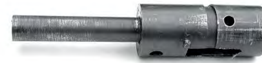
Взаимное расположение затыльника воздушного цилиндра и его крышки в собранной винтовке. Хорошо видно, что торец крышки располагается на некотором расстоянии (4 мм) от уступа затыльника. Небольшой цилиндрический выступ и есть тот самый сухарь, который входит в поперечный паз цилиндра
