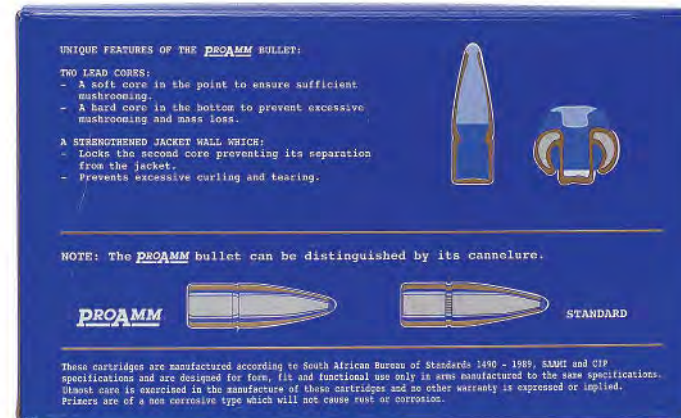
Полуболобочечная пуля патронов PMP серии ProAmm имеет двухкомпонентный сердечник из свинцовых сплавов различной твёрдости для достижения наилучшей проникающей способности вместе с высоким останавливающим действием. Правильной деформации пули при попадании также способствует специальный профиль кольцевой проточки в средней части оболочки пули
