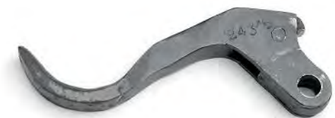
Спусковой крючок с шепталом. Хорошо виден торец штифта, соединяющего эти две детали в единый узел, и соосные отверстия для оси, которая попутно фиксирует затыльник воздушного цилиндра и его крышку
