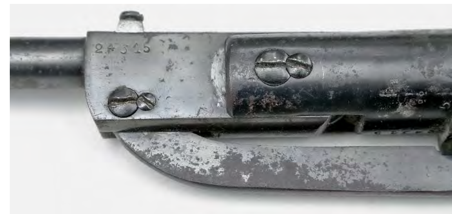
Толкатель поршня не имеет серьги и соединяется с муфтой ствола напрямую, причём не развальцованной осью (как у более поздних ижевских винтовок), а винтом. Обратите внимание на то, что оба винта-оси (ствола и толкателя) имеют небольшие стопорные винты
