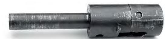
Взаимное расположение затыльника и его крышки в момент выведения сухаря из паза цилиндра
