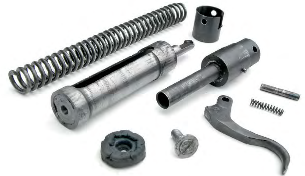
Элементы цилиндра-поршневой группы и спускового механизма: пружина, крышка затыльника воздушного цилиндра, поршень, затыльник, манжета поршня, винт манжеты, спусковой крючок, возвратная пружина крючка, ось крючка. Кольцевая линия с тёмными ушпирениями на передней стенке поршня не что иное, как трещина, по которой он разделился на две части после того, как была отделена манжета. Видимо, некоторое время винтовка эксплуатировалась с поршнем, который держался на «честном слове винта манжеты»
