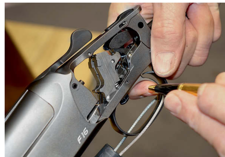
Общий вид на ударно-спусковой механизм нового двуствольного ружья Blaser F16. УСМ куркового (в отличие от ружья F3) типа, боевые пружины витые цилиндрические, расположенные в вертикальной плоскости, шептала верхние, спуск один с селектором
