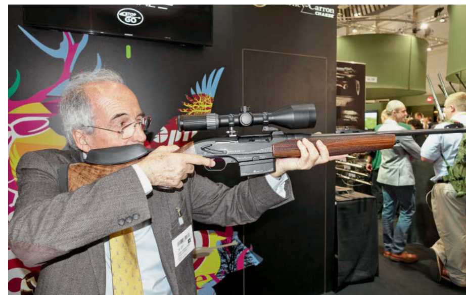
Французская компания Verney-Carron показала новую версию своего самозарядного карабина Impact LA, модель Speed-line, стрельба из которого возможна только в полусамозарядном режиме. При каждом выстреле затвор остаётся в заднем положении на задержке и для продолжения стрельбы необходимо нажать большим пальцем специальную клавишу, расположенную на коробке справа, и вернуть затвор в переднее положение. Такая система подходит для рынков тех стран, где запрещён оборот самозарядного оружия
