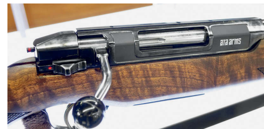
Общий вид на ствольную коробку с затвором первого турецкого магазинного карабина, показанного компанией ATA Arms, на первый взгляд не вызывает особых эстетических чувств. Угол подъёма рукоятки затвора составляет 60 градусов, что удобно при перезарядке оружия. Трёхпозиционный предохранитель, наоборот, особого доверия пока не вызывает
