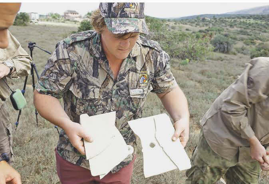
Новые материалы для испытаний пуль в искусственных тканевых средах. На снимке – пластины, имитирующие кости
