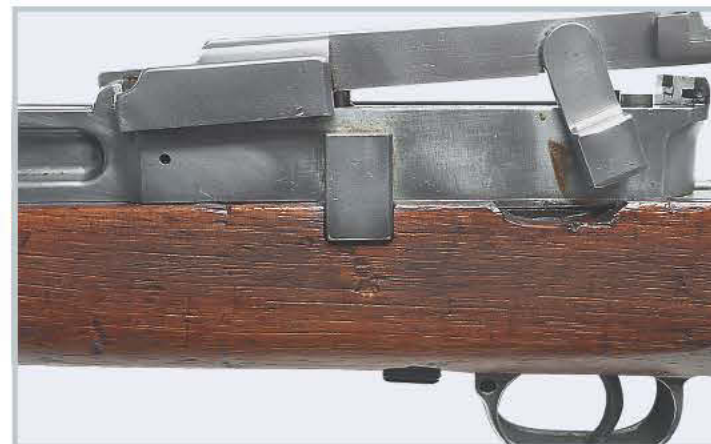
Массивная: у винтовки модели 1909 г. ствольная коробка снабжена весьма массивной крышкой.
