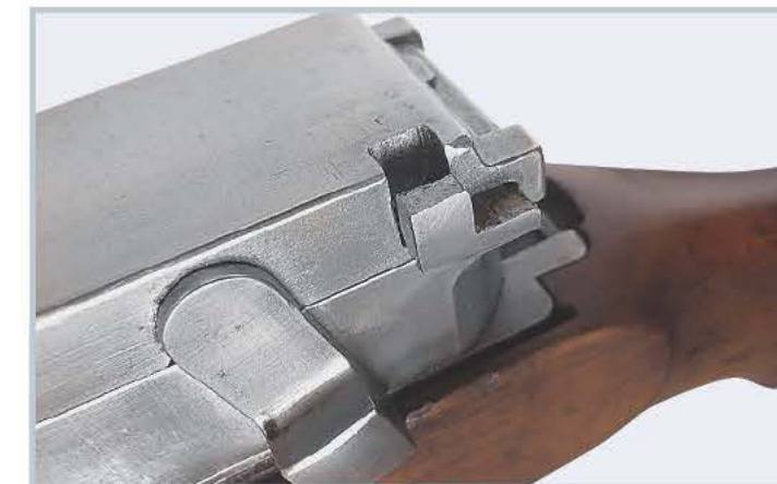
Выключен: на этом фотоснимке хорошо видно, что стопор, который фиксирует крышку ствольной коробки, находится в выключенном состоянии.
