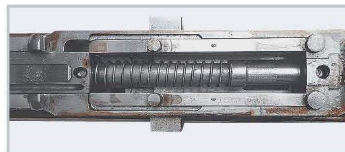
Произошло отпирание: в ствольной коробке с правой и с левой стороны видны два боевых упора (левое фото). Здесь представлено положение после отпирания, когда затвор может скользить назад. Цапфы взаимодействуют с кулачковыми пазами ползуна затвора, перемещающегося в крышке ствольной коробки, которые, как показано здесь, отжимают цапфы наружу, освобождая затвор.
