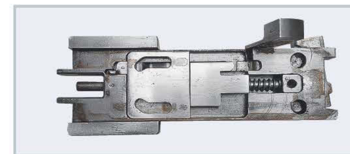
Произошло отпирание: в ствольной коробке с правой и с левой стороны видны два боевых упора (левое фото). Здесь представлено положение после отпирания, когда затвор может скользить назад. Цапфы взаимодействуют с кулачковыми пазами ползуна затвора, перемещающегося в крышке ствольной коробки, которые, как показано здесь, отжимают цапфы наружу, освобождая затвор.
