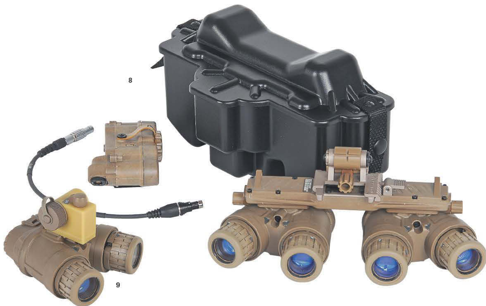
8. Упаковка: жёсткий транспортировочный контейнер предохраняет GPNVG от грязи и повреждений, когда он не применяется и снят со шлема. Слева видны батарейный отсек и кабель питания. 9. Насадка: если спаренный прибор применяется отдельно, его можно снять с перемычки и установить на нём блок питания. 10. Указатель направления: небольшой компас, указывающий направление при нажатии кнопки.
