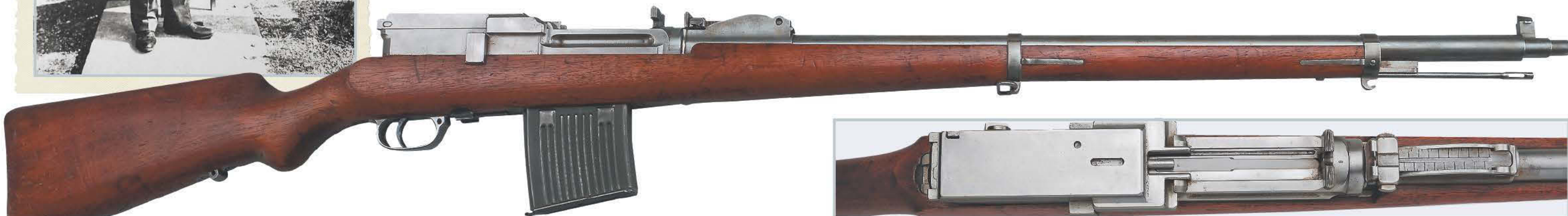
Внизу слева. Реальный образец: на снимке показана самозарядная винтовка Маузера модели 1909 г., серийный номер 6, с неподвижным стволом и запирающим качающимися боевыми упорами. Вверху. Принцип запирания: разрез делает наглядным работу ползуна затвора: синим цветом – затвор, красным – боевые упоры, зелёным – ползун затвора. Внизу справа. Вид сверху: на снимке показана сверху ствольная коробка с затвором и прицел. Между прицелом и рукояткой затвора хорошо виден набитый серийный номер «6».
