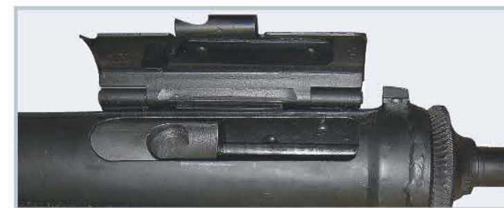
Давно известно. Крюк на пылезащитной крышке служит для фиксации затвора во взведённом и крайнем переднем положении, как и у американского прототипа.
