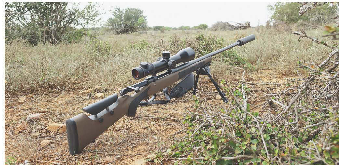
Один из «маузеров» был представлен в модификации с регулируемым гребнем приклада, внушительным глушителем и сошками. Прицел - Victory V8 2,8-20x56. В африканских сафари глушитель иногда используется в целях сохранения стад животных на их обжитых угодьях и меньшего спугивания при выстреле
