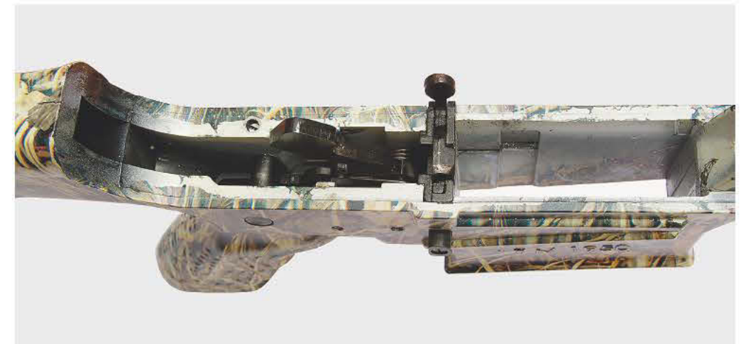
УСМ собран в нижней части коробки и достаточно обычен по устройству
