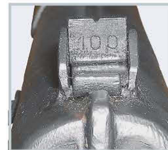
Вариация: вместо диоптрического прицела применён открытый перекидной прицел на две установки (50 и 100 м).
