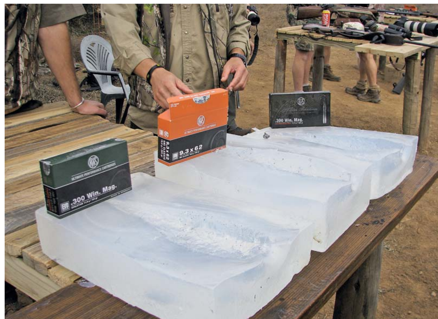
Стрелковое тестирование патронов RWS и изучение действия пуль различных типов проводилось посредством стрельбы по желатиновым блокам
