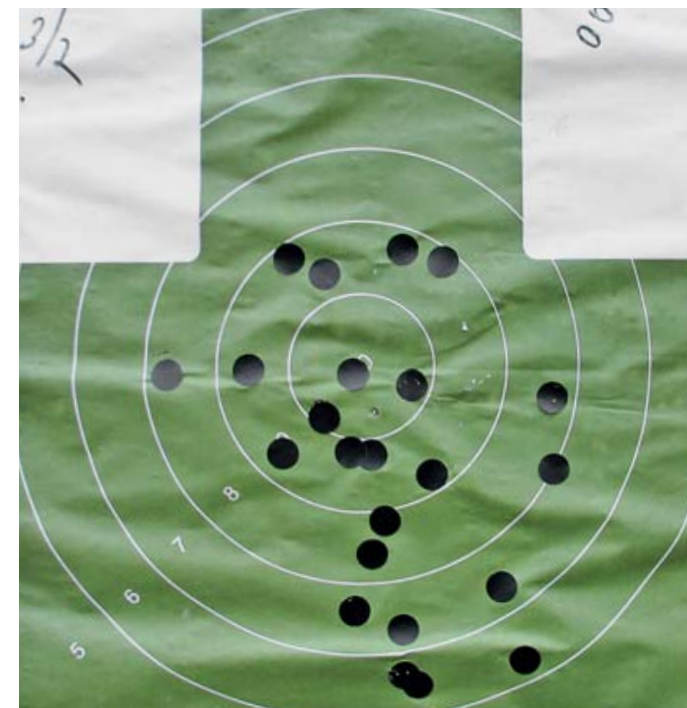
На снимках хорошо видно сгущение попаданий к центру при стрельбе из «Марала», что объясняется более удобными прицельными приспособлениями. На мишенях не заклеены попадания пуль малых калибров, выгущенных из других образцов оружия
