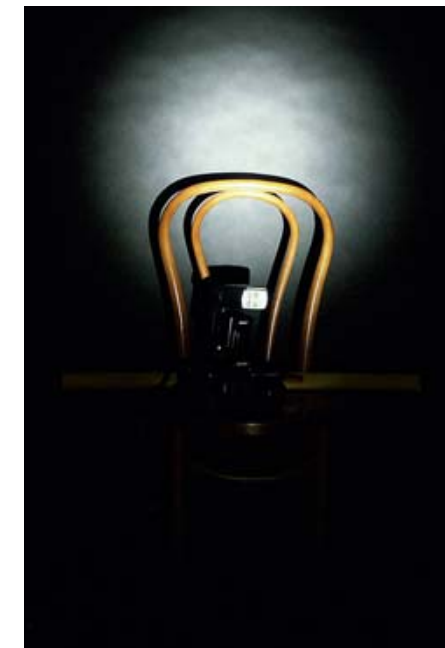
Так выглядит тот же самый объект, сфотографированный в тех же условиях, но освещённый фонариком с хорошо выполненной ручной фокусировкой. Уровень светоотдачи чуть меньше, чем на снимке «С» фабрично сфокусированного фонаря. Как видим, при тесной фокусировке световое пятно получается немного уже, а его освещённость сопоставима. При широкой фокусировке световое пятно значительно увеличивается, оставаясь при этом практически равномерным (это хорошо!), но его освещённость заметно падает, так как свет рассеивается на более широкой поверхности. Такая фокусировка может пригодиться например при ремонтных работах или при чтении карты в темноте
