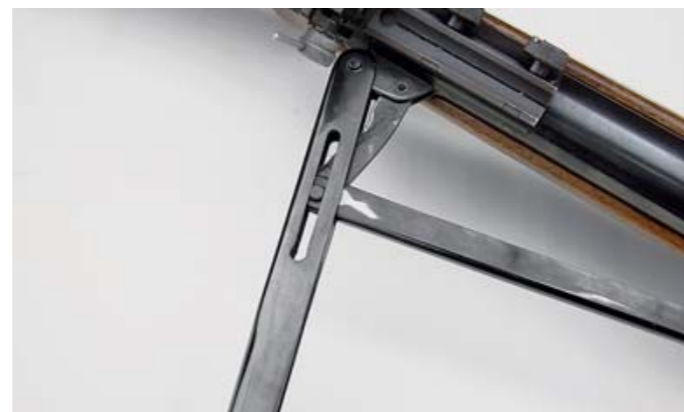
Рычаг взвода соединяется со своей тягой с помощью оси, перемещающейся в длинной прорези. Это позволяет избежать увеличения усилия на рычаге в конце сжатия пружины за счёт изменения отношения плеч действующих сил
