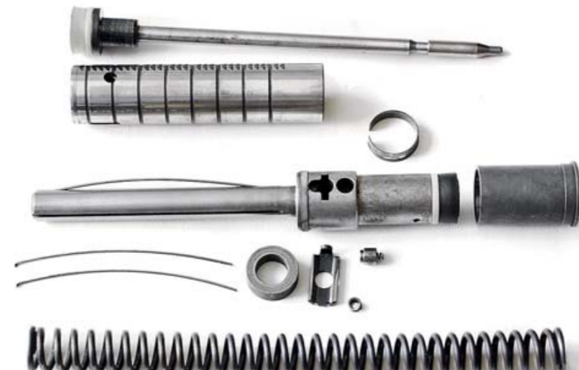
Элементы цилиндра-поршневой группы, сверху вниз, слева направо: основной воздушный поршень с манжетой и штоком (неразъемная сборка); основной воздушный цилиндр, стопорное кольцо основного цилиндра; вспомогательный воздушный поршень с одной из трёх упругих проволочек; вспомогательный воздушный цилиндр; две остальные упругие проволочки; упорное кольцо; рамка-шептало; спиральная пружина рамки; подпружиненный ролик-фиксатор; пружина поршней
