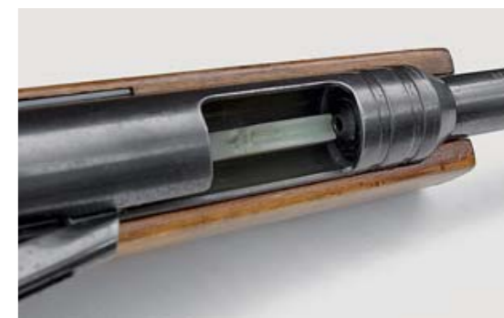
Спусковой механизм во взведённом положении. Хорошо виден выступ ударника шнеллера и ролик, облегчающий взвод ударника задним концом планки привода лотка досылания
