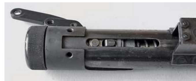
Задняя часть ствольной коробки (спусковой механизм отделен). В прорези хорошо видны ролик-фиксатор (слева) и язычок рамки-шептала, удерживающей воздушные поршни в сцепленном положении
