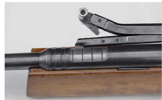
Перед выстрелом рычаг взвода соединяется с тягой защелки. При хранении винтовки их целесообразно расцепить, чтобы не подвергать уплотнение основного воздушного цилиндра постоянным сжимающим нагрузкам
