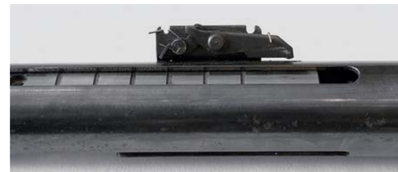
Поднимающийся пластиковый лоток существенно облегчает досылание пули в канал ствола
