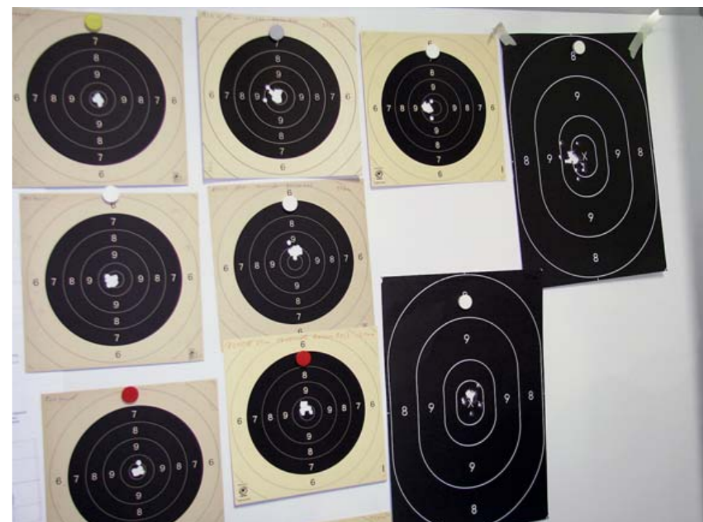
В pistolетном тире завода мы застали контрольный отстрел новых патронов RWS Hexagon 9mm Luger, которые при стрельбе со станка показывали выдающуюся кучность
