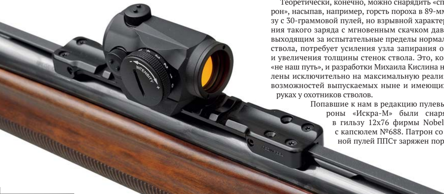
Переходник Recknagel позволяет установить на вентилируемую ружейную планку любой лёгкий прицел через захваты стандарта Weaver. Изделие выполнено очень качественно – обратите внимание на латунный «пятачок» регулировочного винта, выбирающего горизонтальный зазор в зависимости от ширины планки и комплектные винты разной длины, обеспечивающие культурный монтаж переходника на планки разной высоты
