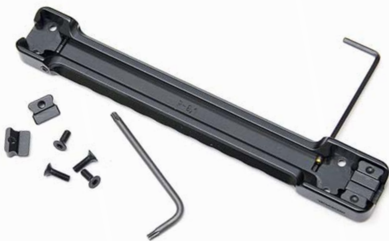
На полуавтомат Breda Echo мы смонтировали Aimpoint Micro H-1, используя планку-переходник Recknagel. Со столь лёгким прицелом крепить переходник, используя все шесть комплектных вкладышей, необязательно – достаточно четырёх. Гораздо важнее, что наличие на одном из концов переходника двух рядов разнесённых по длине пазов для вкладышей. Это позволяет без проблем закреплять переходник на вентилируемых планках с разным шагом стоек
