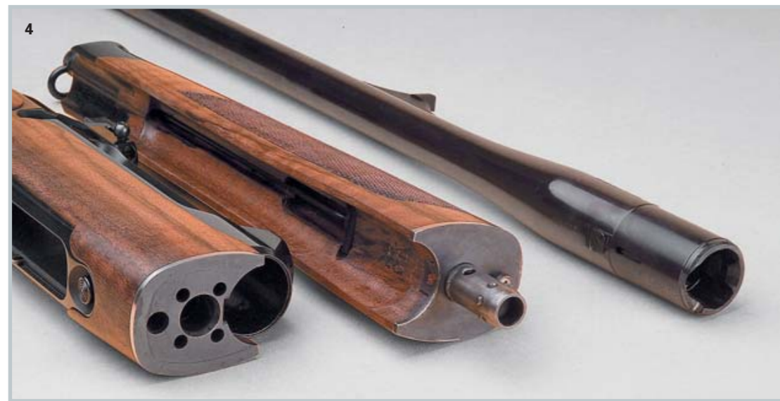
4. В разобранном виде: цевье и стыкующаяся с ним передняя часть приклада со стержнями и ответными отверстиями, а также ствол. Казённая часть ствола вставляется в соответствующее отверстие ствольной коробки, при этом направляющей служит носик на казённой части ствола. 5. Отличительная черта: отличительной чертой многозарядного карабина Sauer 202 Take Down является раздельное цевье.
