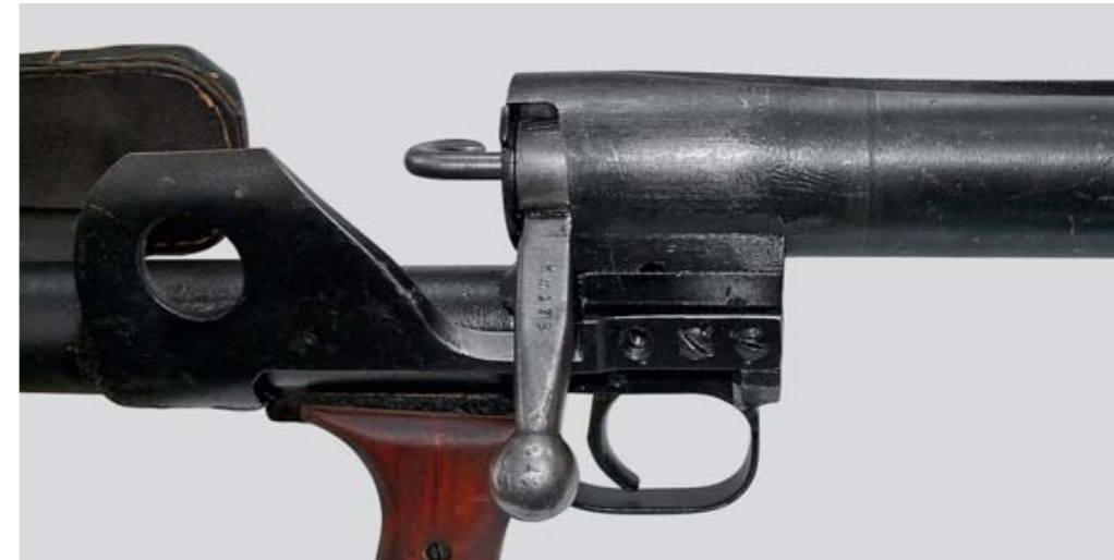
Вид на заднюю часть затвора и копир четвертьавтоматики ПТРД. Затвор в запёртом положении
