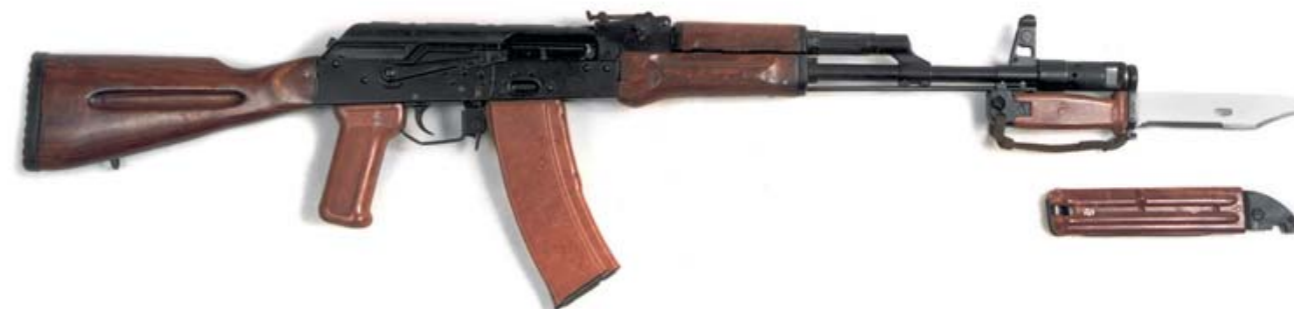
5,45-мм автомат АК-74 (инд. 6П20), принятый на вооружение в 1974 году.
