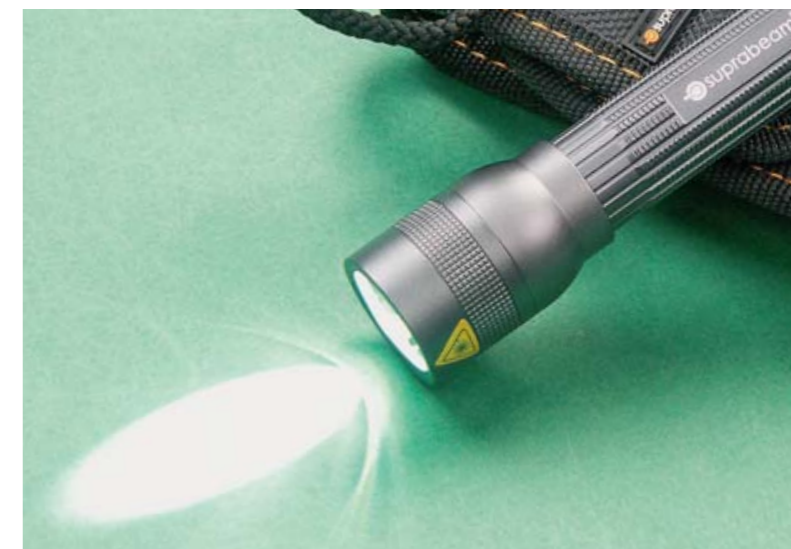
Фонарик Q2 оборудован ручной фокусировкой, дающей возможность выбора между более слабым, но более равномерным освещением большей поверхности, что может пригодиться при малых расстояниях до освещаемых предметов, и сфокусированием светового потока до интенсивно освещённого, но небольших размеров пятна
