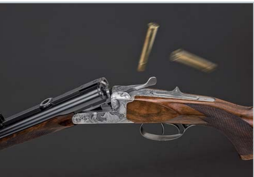
Универсальность: механизм извлечения стреляных гильз может работать как эжектор и как экстрактор. Когда необходимо быстро перезарядить оружие, ползун-нагнетатель следует установить в переднее положение: стреляные гильзы будут выбрасываться. Когда их нужно только частично извлечь, ползун-нагнетатель должен быть установлен в заднем положении.
