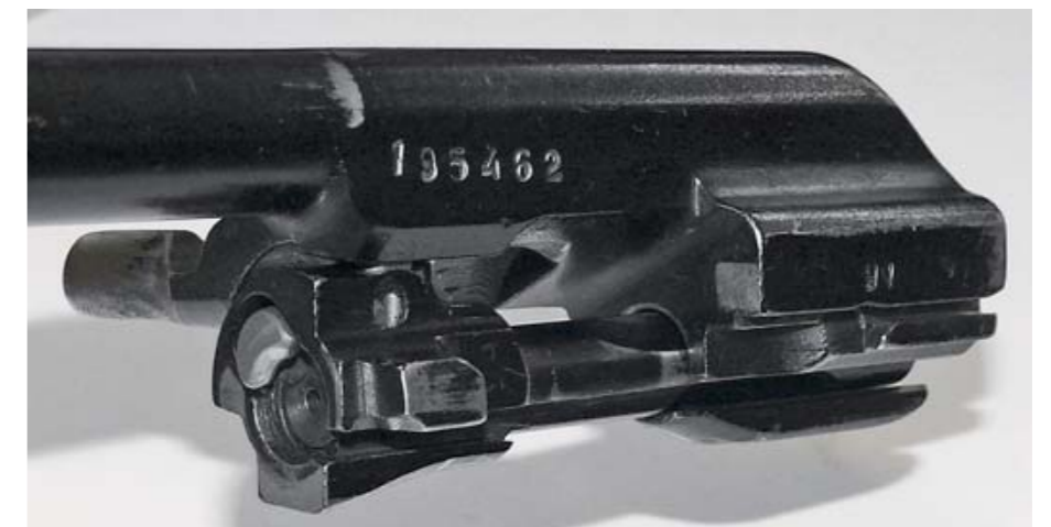
Затворная рама АКМ с затвором в сборе
