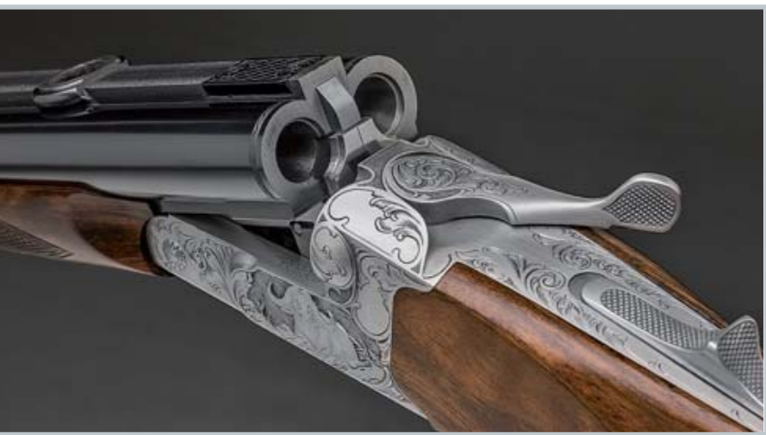
В открытом состоянии: в открытом состоянии угол наклона стволов относительно невелик, но вполне достаточен для заряжания или разряжания оружия. В казённой части ствол находится не болт Гринера, а выступ Пёрде.
