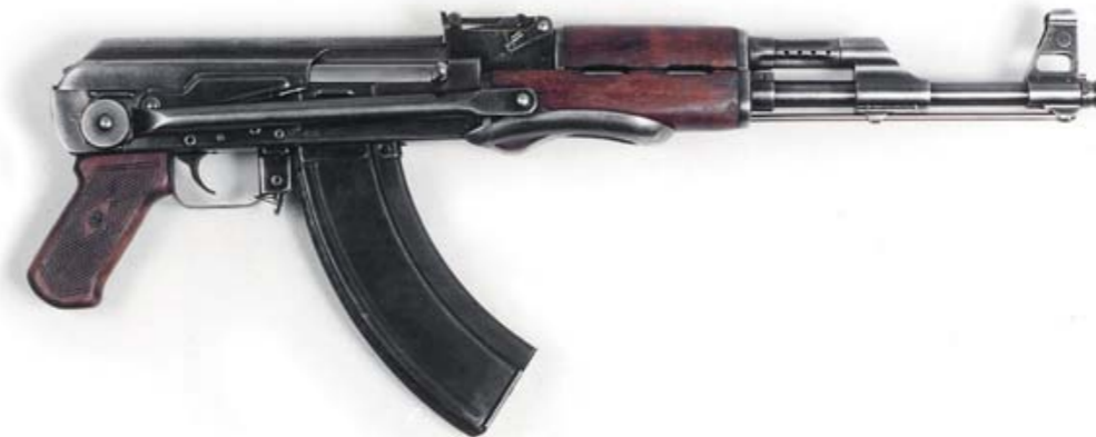
7,62-мм автомат АКС (инд. 56-А-212М), принятый на вооружение Советской Армии в 1949 году.
