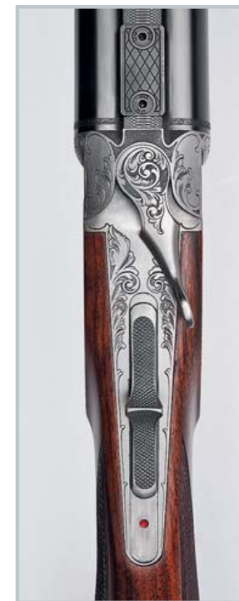
Эргономичность: ключ запирающего механизма и ползун-нагнетатель соответственно расположены на широком хвостовике.
