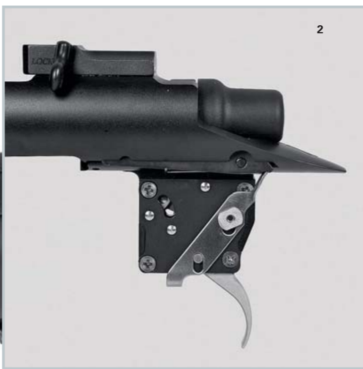
1. Установлен: шариковый спусковой механизм Бикс-н Анди, встроенный в Remington 700. 2. Хорошо упакован: корпус спускового механизма сделан из высокопрочного алюминиевого сплава и анодирован. 3. Регулируемый: усилие спуска регулируется сменными пружинами. 4. Безопасный: спусковой механизм поставляется в комплекте с предохранителем.
