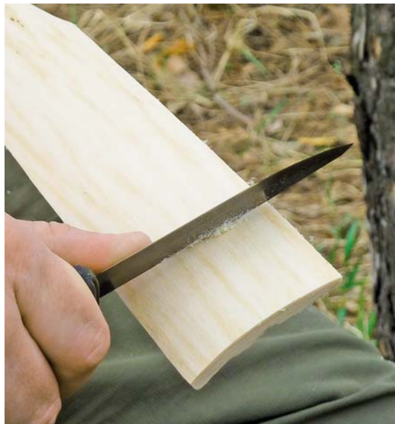
Выравнивание поверхности осиновой лопаточки острой кромкой обуха клинка
