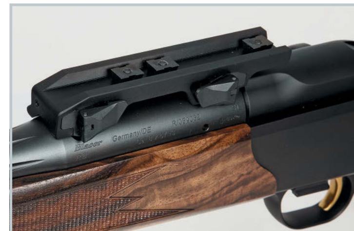
Навстречу друг другу: у кронштейна Innomount передний рычаг при стопорении поворачивается назад, а задний рычаг – вперёд. В запорном состоянии рабочие поверхности рычагов входят в корпус кронштейна и на них невозможно воздействовать случайно.
