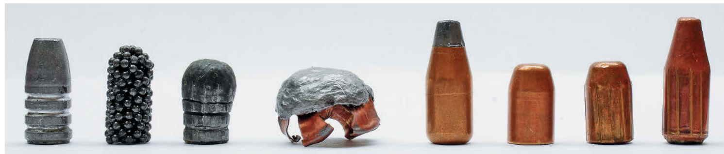
Для нового патрона разработана целая гамма (свинцовая, свинцовая в полимерной оболочке, оболочечные разной массы и оболочечная) пуль и даже дробовой снаряд. В центре 15-г оболочечная пуля, «сработавшая» по блоку-имитатору
