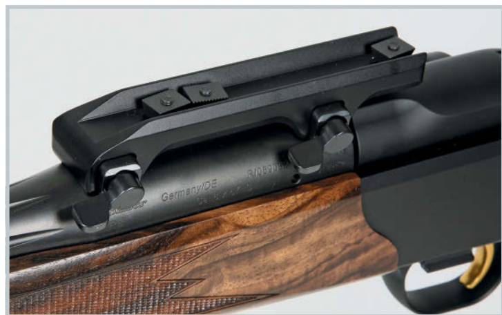
МАKuick: этот быстростъёмный кронштейн имеет высоту установки 12 мм. Зажимные рычаги, расположенные на левой стороне, для затяжки поворачиваются назад. Усилие поджатия рычагов можно регулировать инбусными винтами.
