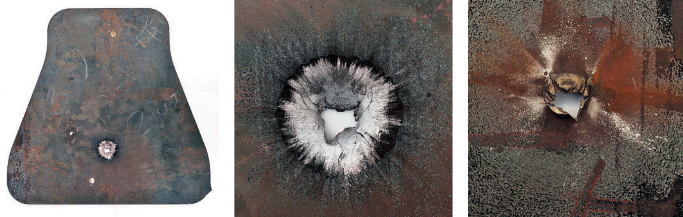
Илл.3 Результат «редакционной пулевой пробы» по современному аналогу бронепанели СН-39 (3,8 мм) из СВД лёгкой пулей с дистанции 15 м поразительной похож на результат «войсковой пробы» (илл. 2)
