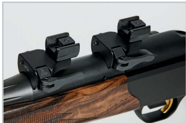
Две стойки: накидной кронштейн EAW состоит из двух стоек. Из представленных здесь кронштейнов он имеет наибольшую высоту установки – 19,5 мм. Зажимные рычаги складываются в продольном направлении. У них большие рабочие поверхности для удобства в обращении.
