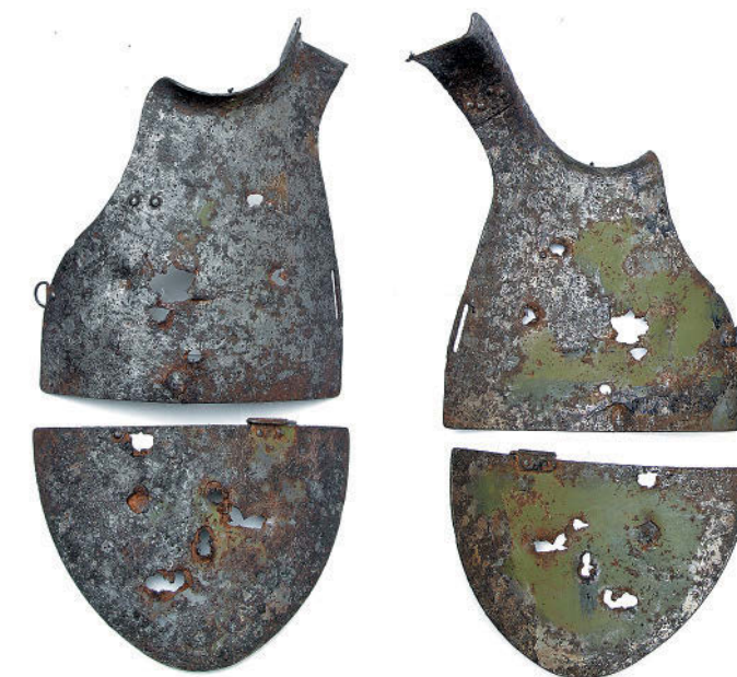
Илл. 2 Лицевая и оборотная стороны бронепанелей СН-39 (3,7 мм), найденные поисковиками в районе сосредоточения 3 бат. 355 сп 100 СД перед наступлением в окрестностях д.Сумма. Бронедетали имеют явные следы «войсковой пулевой пробы» - стреляли и с лицевой и с оборотной сторон, с близкого расстояния
