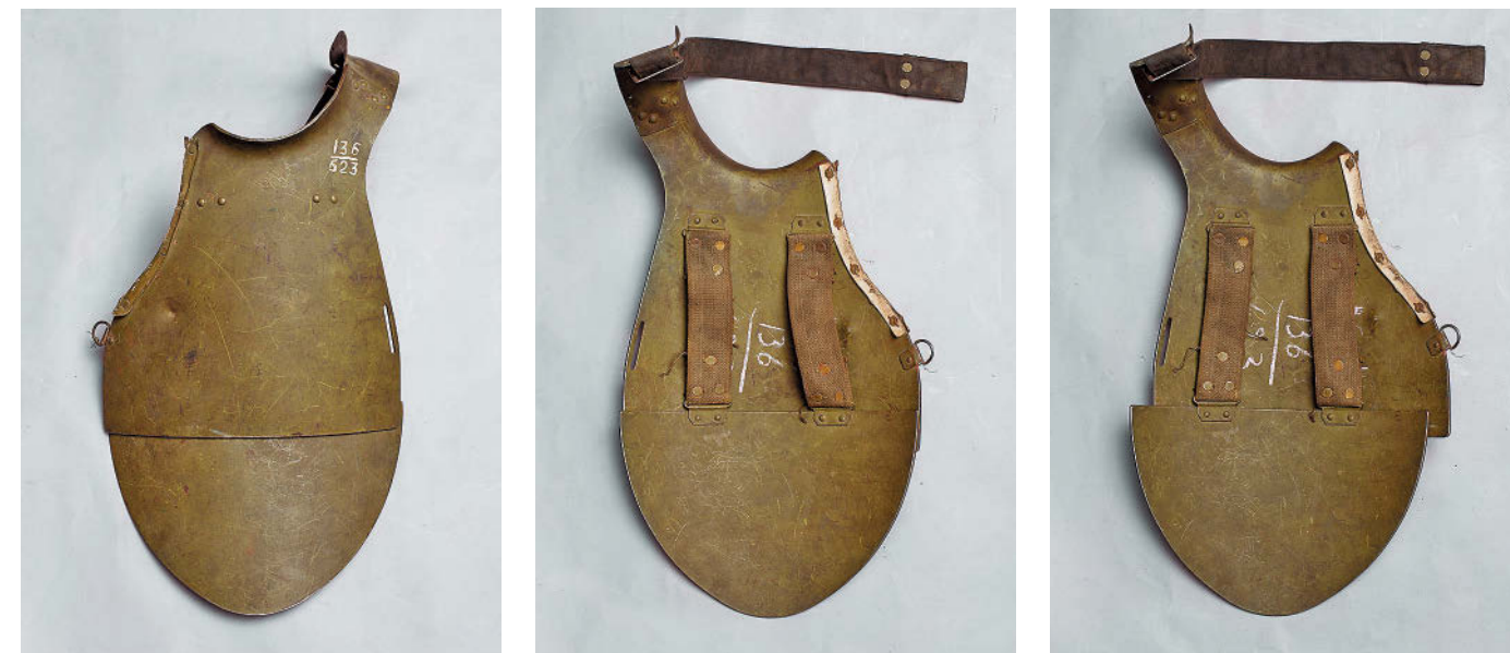
Илл. 1 Лицевая и оборотная стороны СН-39 (3,7 мм) из коллекции ВИМАИВ и ВС. На верхней секции след «пулевой пробы». Клёпка петель подвеса «паховой» секции произведена «на колонке», что привело к не совпадению профилей секций
