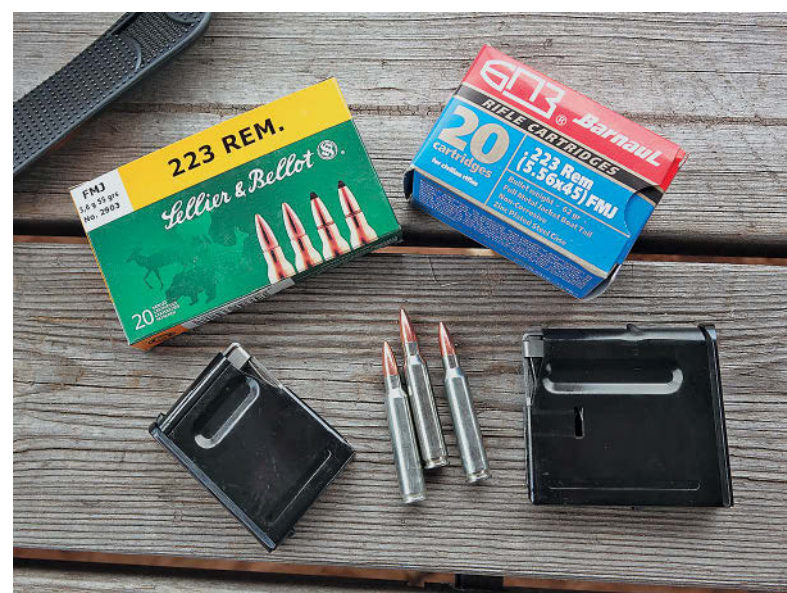
На тестировании карабинов использовались патроны калибра .223 Rem. двух марок: Sellier & Bellot с пулей 3,6 г типа FMJВ и БПЗ с пулей 4,0 г типа FMJBT. Внизу – два магазина: на 3 и 5 патронов
