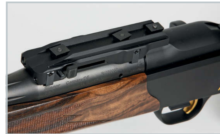
Один рычаг: кронштейн HMS Swift от компании Henneberger также представляет собой единый узел. Но стопорение осуществляется одним рычагом, который приводит в действие обе стопорные цапфы одновременно. Предохранительный штифт спереди препятствует произвольному открыванию.
