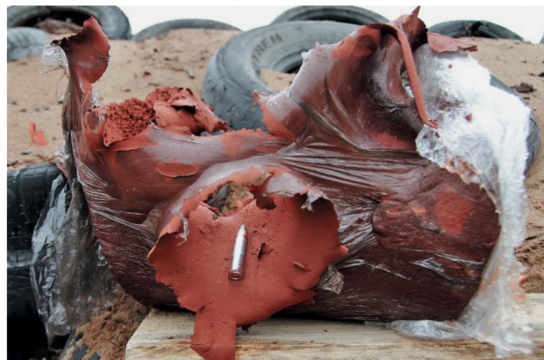
Результат попадания 15-г оболочечной пули патрона 9,5x39 патрона по блоку из скульптурной глины толщиной более 30 см. Дистанция 50 м
