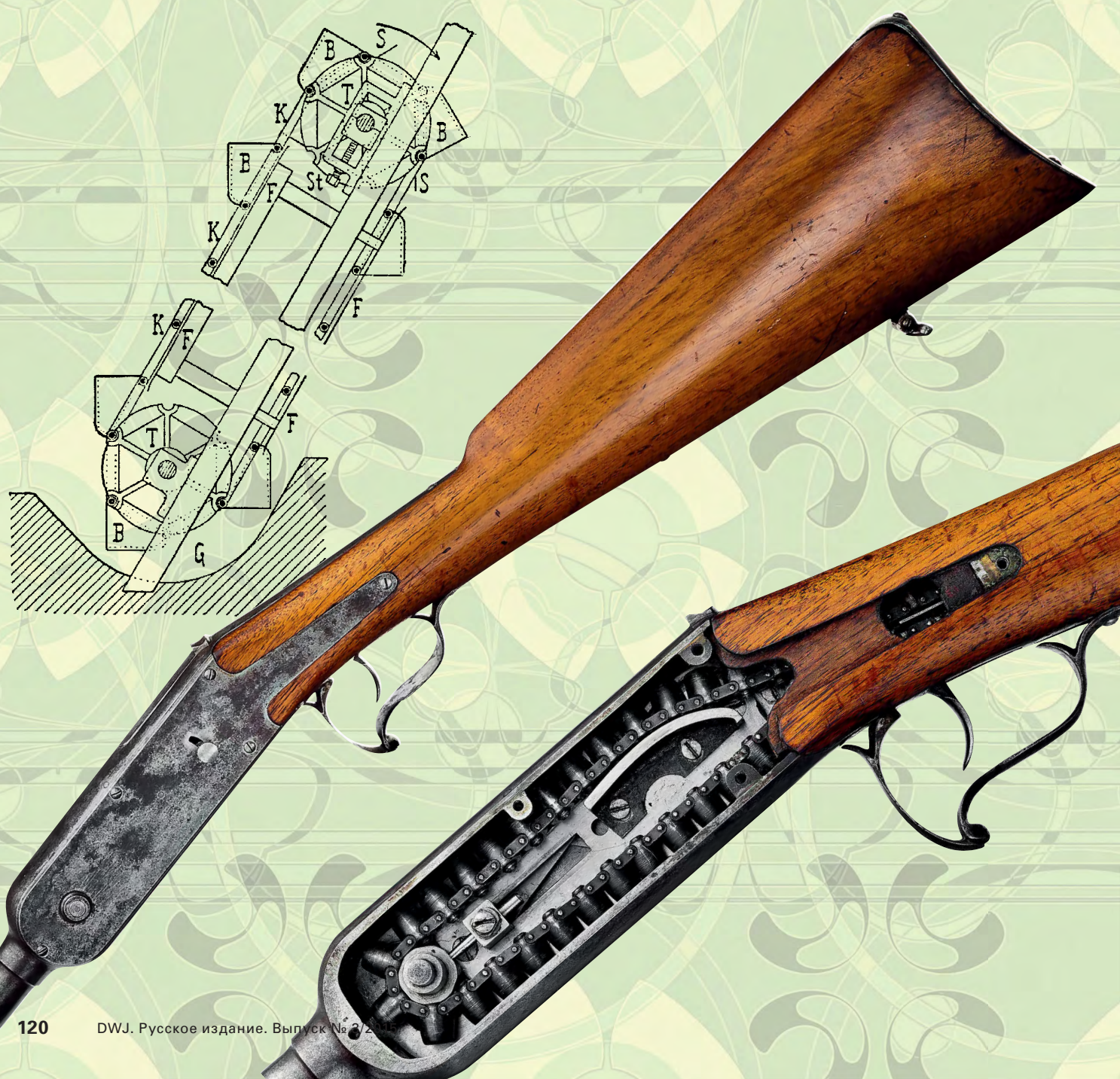
1. Немецкий патент 7053 от 14 октября 1879 г.: здесь нет подвижного ствола, вместо этого имеется подвижная уплотнительная гильза.
