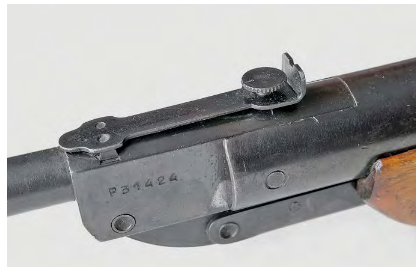
Регулируемый прицел ПСРМ. Вертикальные поправки вводятся с помощью винта с большой головкой, упирающегося своим нижним концом непосредственно в муфту ствола. Горизонтальные поправки вводятся перемещением всего узла в «ласточкин хвосте», что требует применения подходящих инструментов
