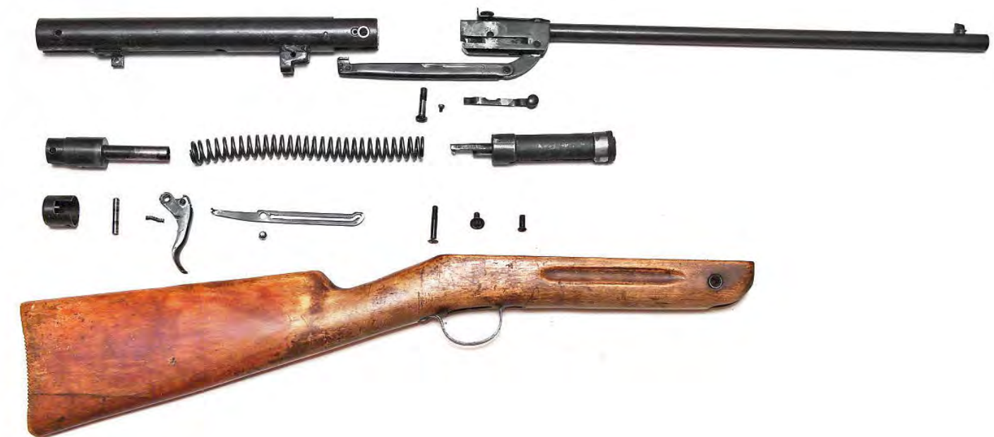
Полная разборка винтовки ПСРМ, слева направо, сверху вниз: воздушный цилиндр; ствол с прицельными приспособлениями, шатуном и толкателем поршня; винт-ось ствола; стопорный винт оси ствола; ползун; затыльник воздушного цилиндра; пружина поршня (старая); поршень; крышка затыльника; поперечный штифт затыльника; возвратная пружина шептала; спусковой крючок с шепталом; автоматический предохранитель и его винт-ось (внизу); задний ложевой винт; передние ложевые винты; ложа со спусковой скобой
