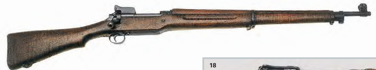
15. Подобная Маузеру: американская винтовка Springfield 1903 имеет ряд конструктивных особенностей немецкой винтовки обр. 98 г. 16. Массивный: затвор винтовки Springfield 03 имеет на головке два боевых упора по типу Маузера.
