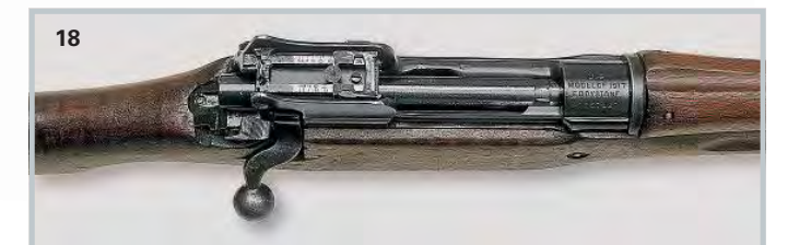
17. Американка: винтовка U.S. P-17 калибра .30-06 Springfield должна была восполнить нехватку в США винтовок Springfield 03. 18. Точная: винтовка U.S. P-17 имела диоптрический прицел на перемычке ствольной коробки, откидывающийся для регулировки.
