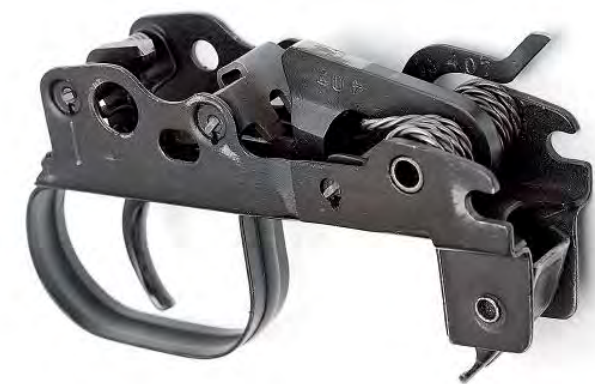
Отделяемый ударно-спусковой механизм СВД: решение, подсказанное опытом армейского оружейного мастера
