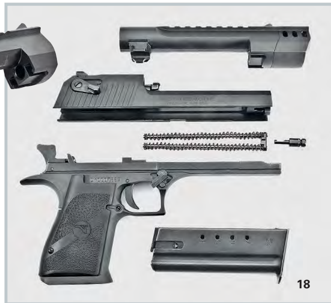
17. Массивность: на стволы с боевыми выступами материала не пожалели. 18. Части пистолета при неполной разборке: на фотографии изображены основные части пистолета Desert Eagle при его неполной разборке. Хорошо различимы двойная возвратная пружина и газовый поршень.
