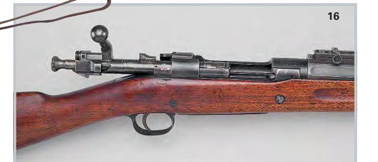
15. Подобная Маузеру: американская винтовка Springfield 1903 имеет ряд конструктивных особенностей немецкой винтовки обр. 98 г. 16. Массивный: затвор винтовки Springfield 03 имеет на головке два боевых упора по типу Маузера.
