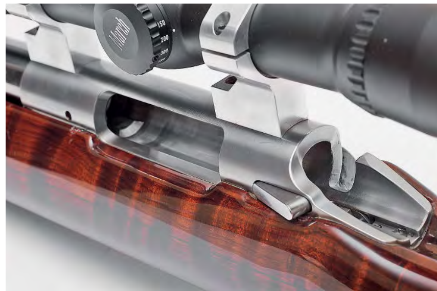
Затворная группа изготовлена из цельной стальной заготовки и имеет очень большой запас прочности. Она вклеена в ложа, что обеспечивает максимальную повторяемость при стрельбе
