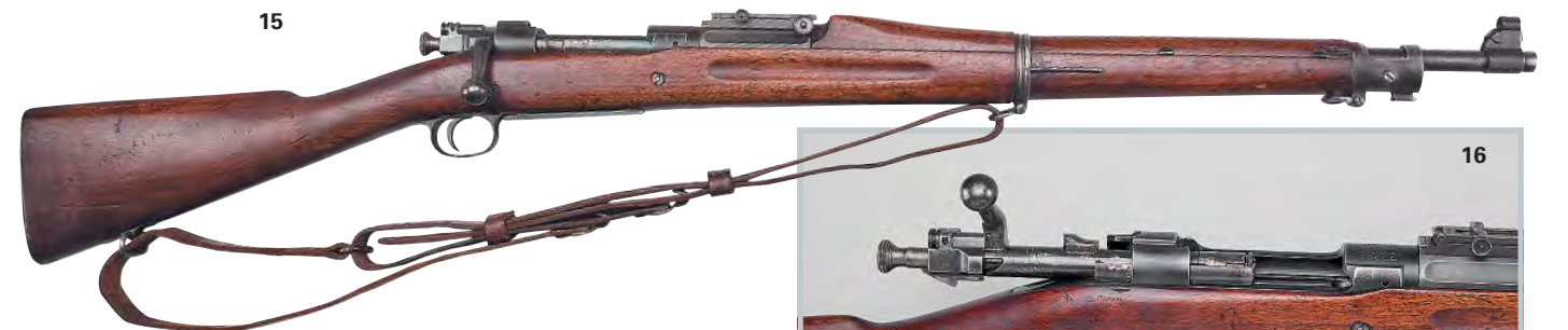
15. Подобная Маузеру: американская винтовка Springfield 1903 имеет ряд конструктивных особенностей немецкой винтовки обр. 98 г. 16. Массивный: затвор винтовки Springfield 03 имеет на головке два боевых упора по типу Маузера.
