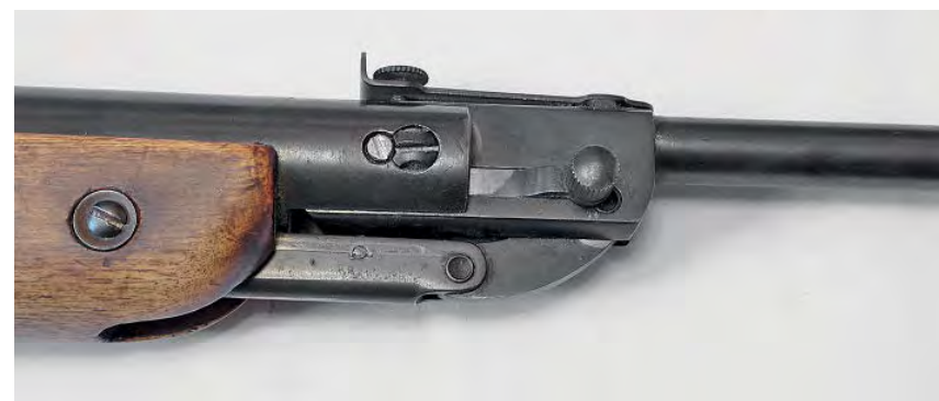
Ползун, облегчающий отпираание ствола, располагается в пазу с правой стороны ствольной муфты. Винт-ось ствола фиксируется маленьким стопорным винтом, входящим своей головкой в один из вырезов головки винта-оси
