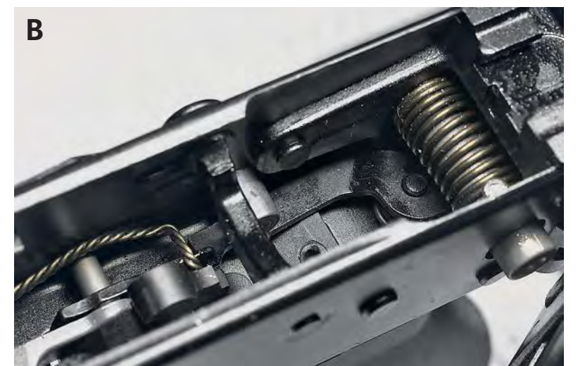
Механизм блокировки УСМ. Виден задний конец блокировочного рычага который выжимается хвостовиком приклада при его установке в боевое положение (А), при этом передний конец рычага входит в вырез спускового крючка блокируя его (В). Фиксация приклада в походном положении осуществляется с помощью неподвижной защёлки на ствольной коробке, в прорезь которой попадает кромка верхней тяги за счёт упругой деформации рамки приклада (Б)
