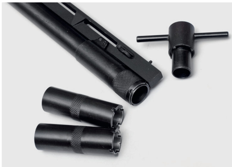
Гладкий ствол может комплектоваться сменными дульными насадками. Обратите внимание на механизм регулировки прицельной планки в её передней части
