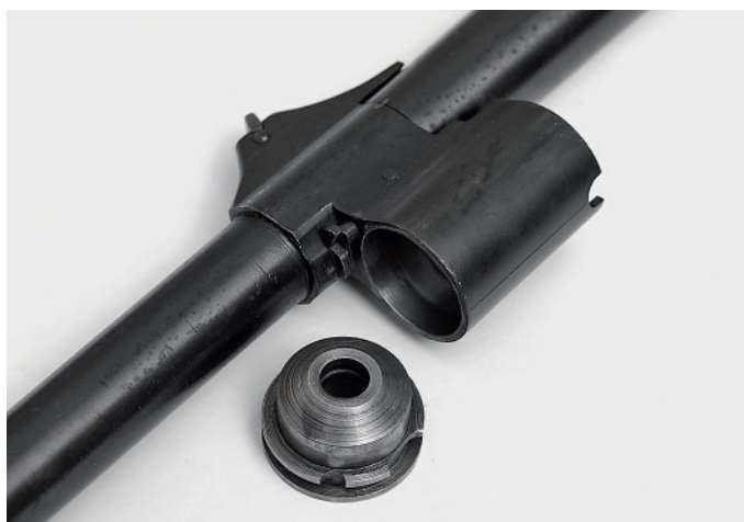
Газовый поршень и шток, соединяющий его с затворной рамой
