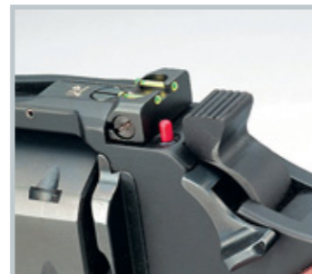
Готов к стрельбе: полностью выдвинутый штифт показывает, что оружие заряжено.
