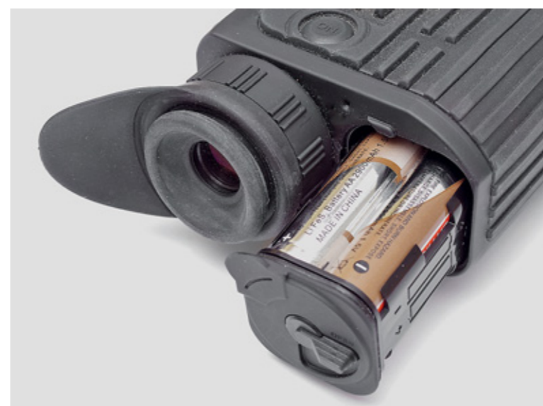
Для быстрой смены контейнера с четырьмя элементами питания типоразмера AA («пальчики») не забудьте повернуть наглазник (фото слева). А чтобы не ошибиться с положением контейнера при установке, он оснащён специальным ассиметричным выступом, который легко зацепить ногтем и при затруднённом извлечении батарейного блока. Будьте аккуратны, при установке батареек в контейнер – следите за пиктограммами полярности на нём (фото справа)
