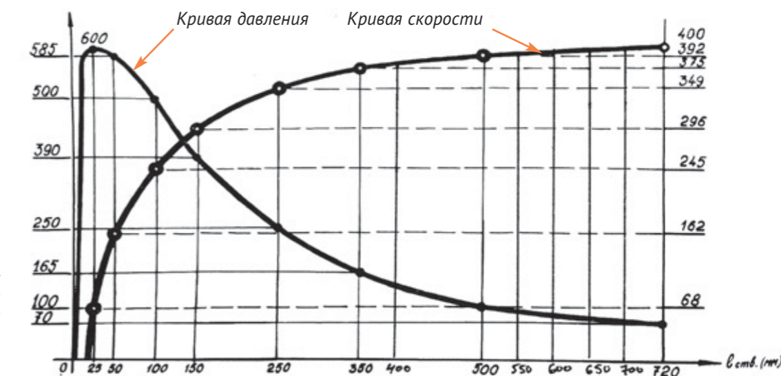
Кривые давления пороховых газов и скорости движения дробового снаряда в конце ствола 12-го калибра длиной 720 мм («Ижевские ружья», 1995)
