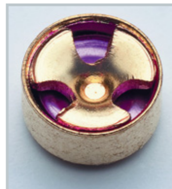
Слева: Подрос. Из-за увеличенного до дюйма диаметра капсюль-воспламенитель не подходит к стандартному гнезду под капсюль. Слева внизу: Мощный. Новый капсюль XLRM обеспечивает необходимую энергию для абсолютно надёжного и, прежде всего, как можно более равномерного сгорания очень широких и высоких цилиндрических зёрен прогрессивного пороха. Внизу: Единственный экземпляр. Матрицы 9,5x70 ELR изготавливает фирма Triebel из Кауфбойрена. Позже они будут изготавливаться серийно.
