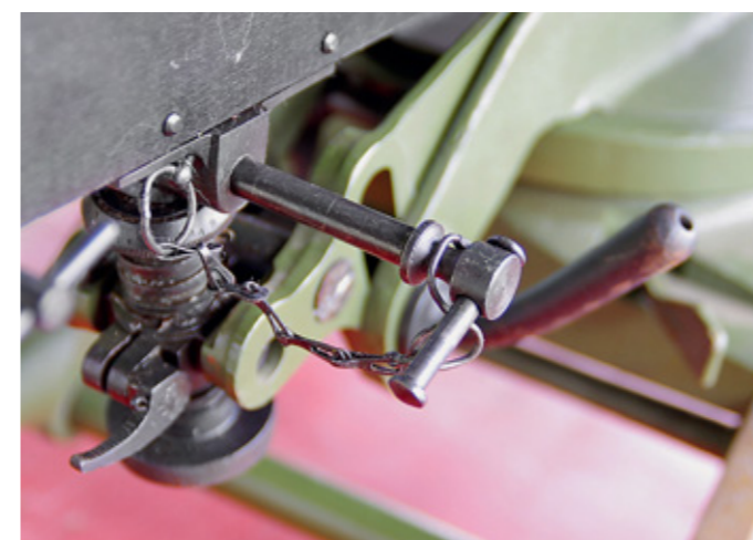
Соединение задней шпилькой при установке тела пулемёта на станок Соколова
