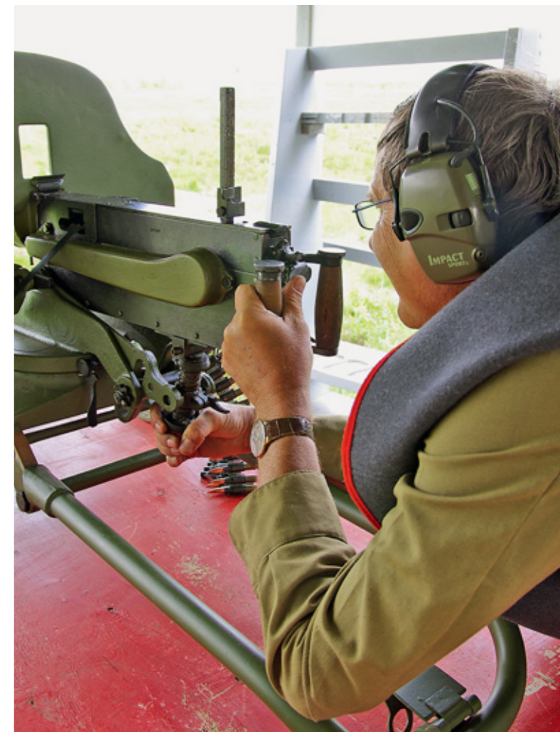
Введение вертикальных поправок при наведении пулемёта на цель при помощи воротка механизма тонкой наводки
