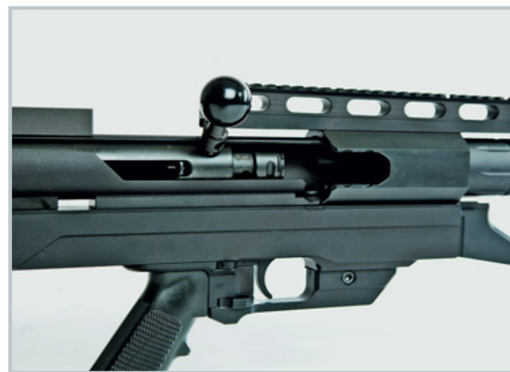
На все случаи. Боковая пластина для заряжания удлиненных боеприпасов выполнена съёмной.
