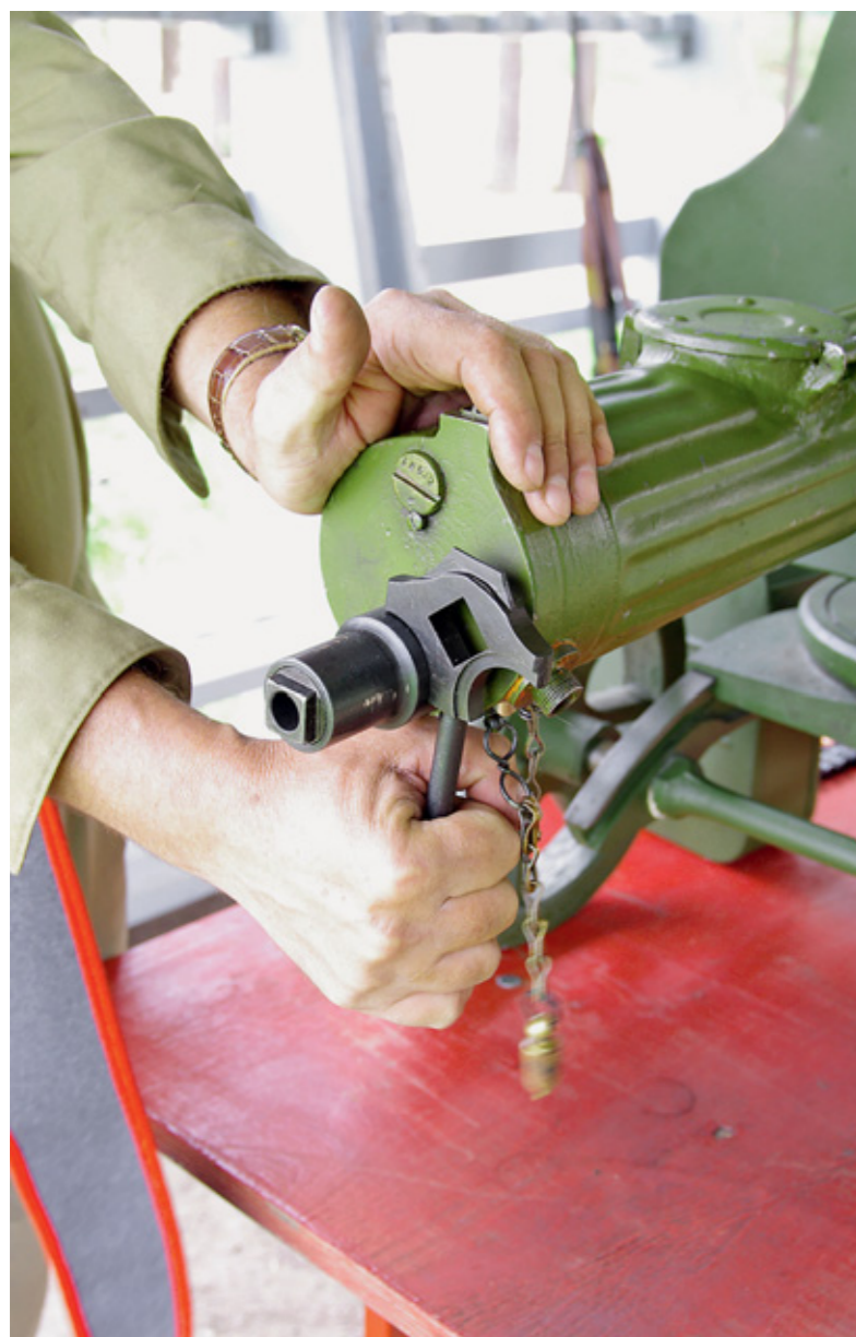
Спецключ вместо рукоятки имеет шестилепестковую фрезу, с помощью которой можно быстро убрать нагар из надульника, хотя и несколько варварским способом
