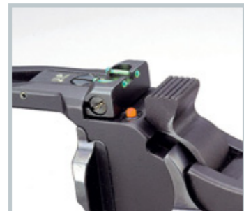
Виден: при откинута барабане сигнальный штифт частично выступает наружу.
