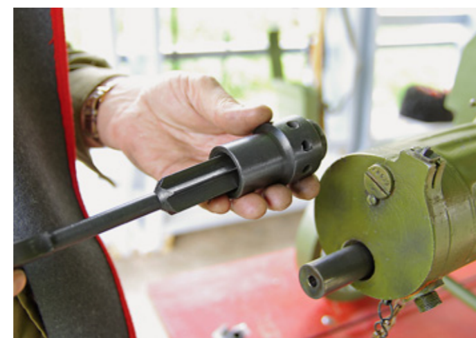
Спецключ вместо рукоятки имеет шестилепестковую фрезу, с помощью которой можно быстро убрать нагар из надульника, хотя и несколько варварским способом
