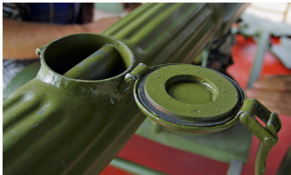
Широкая заливная горловина кожуха на пулемѐтах последней модификации
