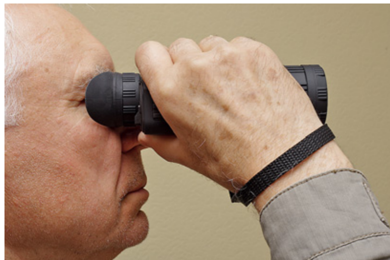
Лепесток на наглазнике защищает зрительный канал от боковых засветок и уменьшает демаскирующий фактор свечения окуляра в тёмное время суток
