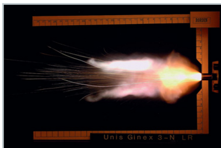
Преодоление. При массе ударного состава 69 мг увеличенный капсюль развивает температуру 4500° С даже при крайне низкой температуре -41° С.
