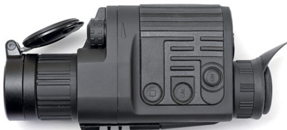
У модели 38S объективная крышка в открытом положении не выступает за габариты прибора – неплохое решение, предохраняющее её шарнир от поломки
