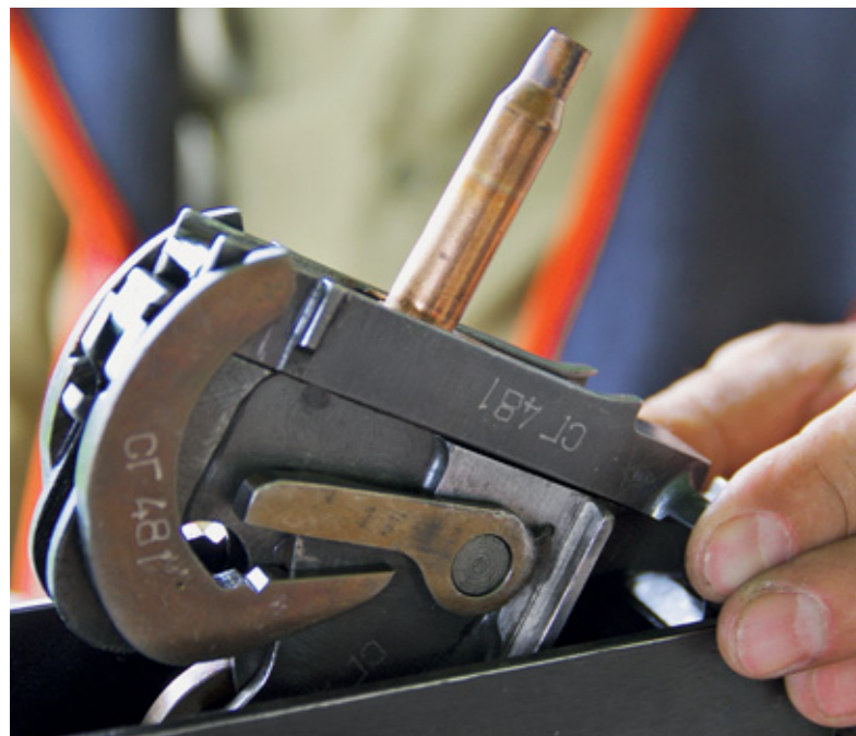
Установка стреляной гильзы в боевую личинку для выдавливания патрона из гильзоотводной трубки при разряжании пулемёта
