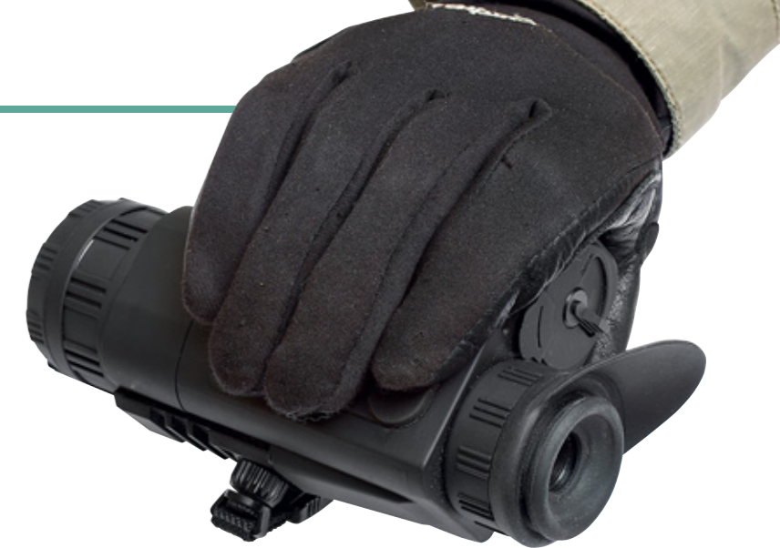
Прибор не идеален с точки зрения тактильной избирательности в зоне кнопок управления. Особенно в перчатках
