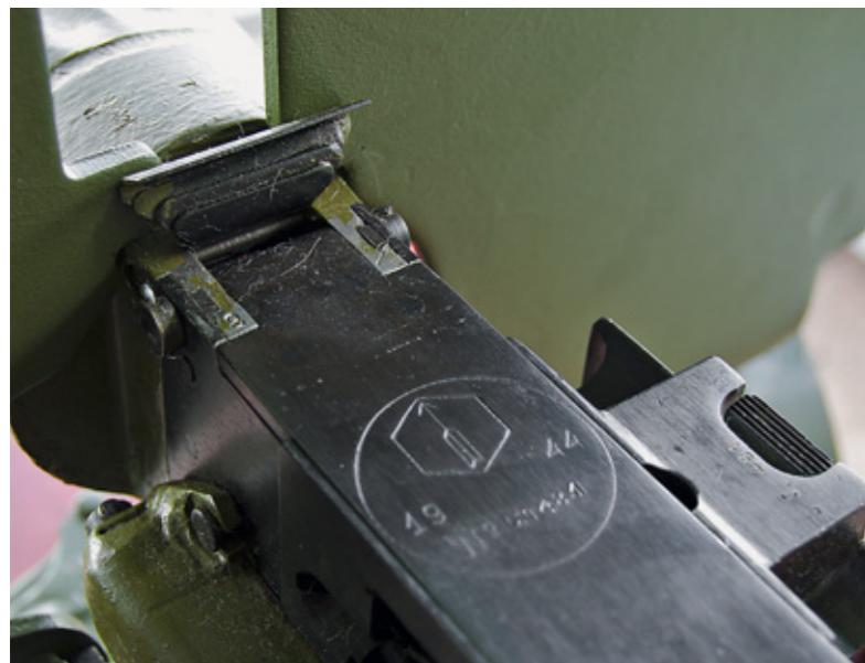
Клеймо завода-изготовителя, год изготовления и серийный номер пулемёта на верхней крышке ствольного короба
