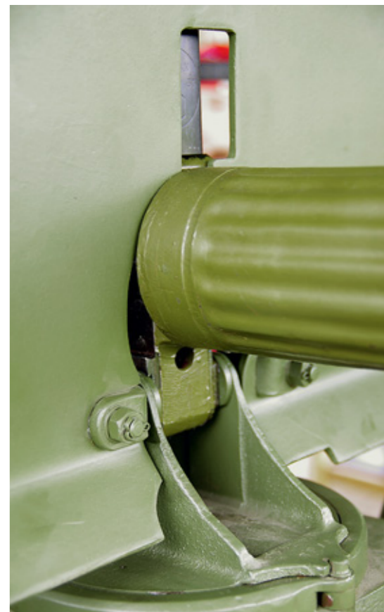
Ниже кожуха хорошо просматривается выходное отверстие гильзоотводной трубки, откуда и вылетают стреляные гильзы при стрельбе
