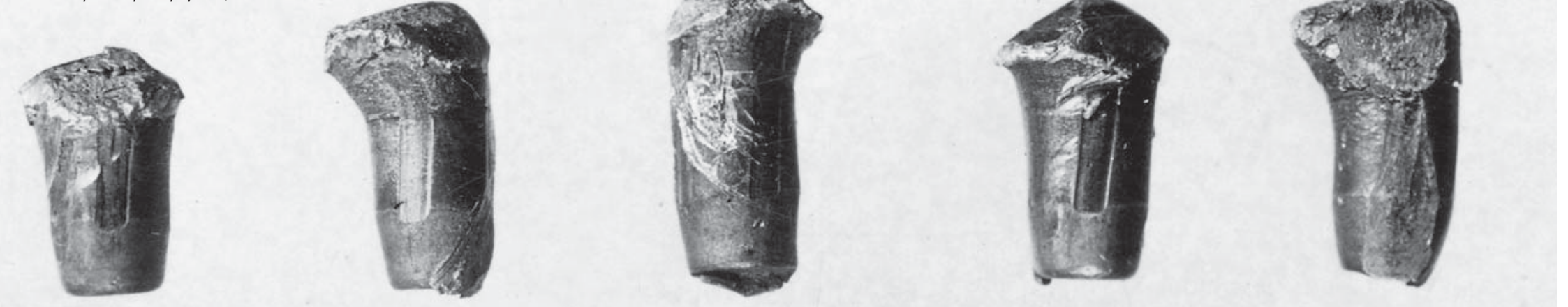
Внешний вид пуль из железного порошка, собранных при определении пробивного действия. Ясно виден характер деформации
