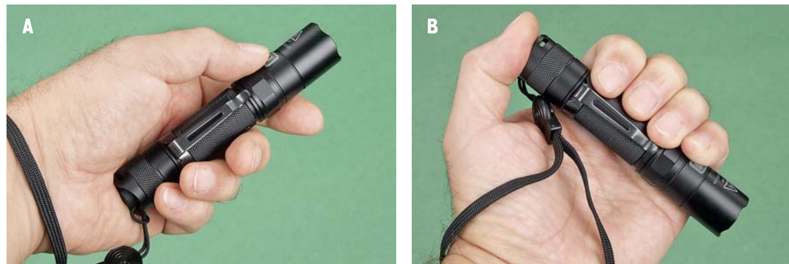
Чтобы оперировать кнопкой выбора уровня и режима светотдачи, надо перехватить включенный фонарик прямым хватом (А). Но можно немного потренироваться и овладеть «искусством» оперирования обоими кнопками, держа фонарик обратным хватом – выключатель нажимаем большим пальцем, а управляющую кнопку – мизинцем (В)
