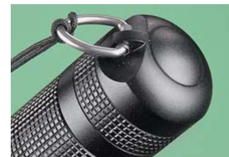
Кнопка выключателя фонарей серии М весьма удобна в работе, но не слишком хорошо защищена от случайных нажатий: на постоянное свечение, правда, не включается, но мигает довольно-таки часто. Чтобы этого избежать, корпус кнопки надо отвинтить на целый оборот, а то и более
