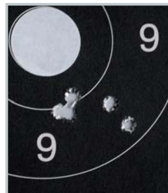
Мишень: поперечник рассеивания 20 мм на дистанции 100 м – это хороший результат.
