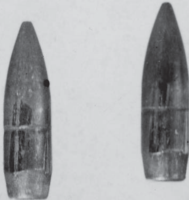
Две пули из железного порошка, прошедшие канал ствола, имеющего настрел 3000 выстр. Ясно видно, что ширина следа на пуле значительно больше ширины поля нарезки
