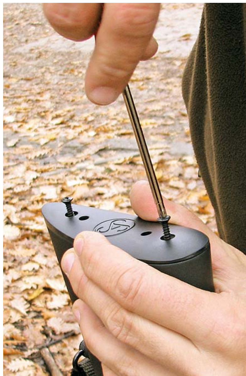
При необходимости перед пристрелкой подгонялась длина приклада, а также устанавливалась нужная высота его гребня
