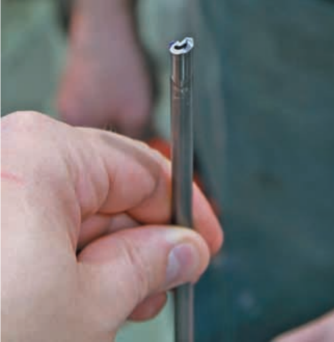
Сверло для глубокого сверления заготовки ствола
