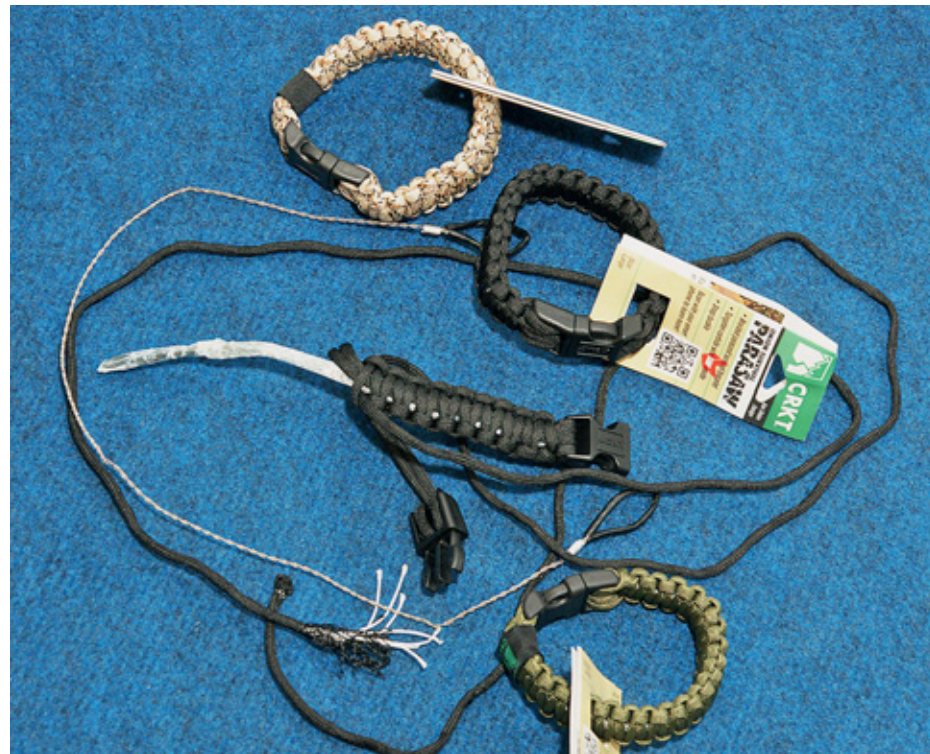
«Браслет выживания» фирмы CRKT. Если его распустить, то получим несколько метров прочного нейлонового шнура, а также тонкий стальной тросик с осажёнными на нём твердосплавными зёрнами и петлями для пальцев на концах. Таким тросиком можно перепилить дерево толщиной 12–15 см, хотя не слишком быстро и удобно. Очень похоже по принципу действия пилы, правда, более топорные с виду, но намного более эффективные по своему действию, входили в состав снаряжения советских спецподразделений лет этак 40–50 назад
