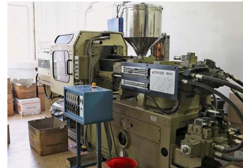
Термопласт автомат за одну смену производит 40000 шт. пластиковых пыжей-контейнеров
