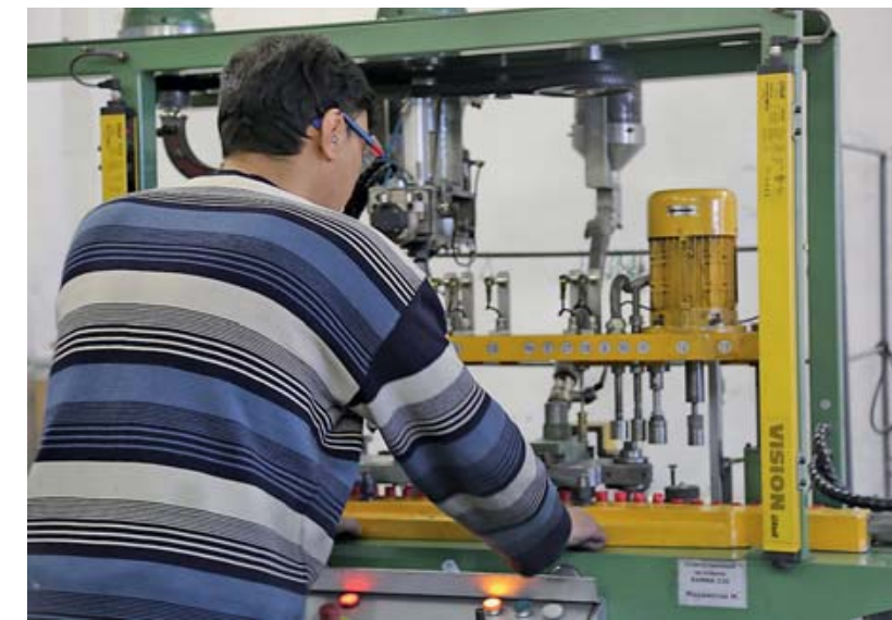
На автоматизированных станках Ramba за смену производится 22000 патронов
