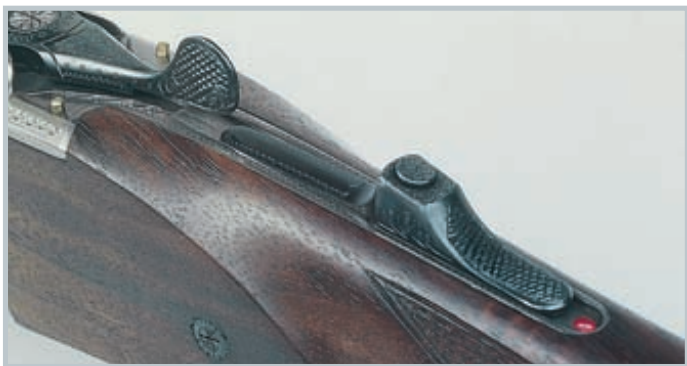
Функциональный: взведение ударного механизма и включение предохранителя осуществляется одним и тем же ползунком на шейке приклада.
