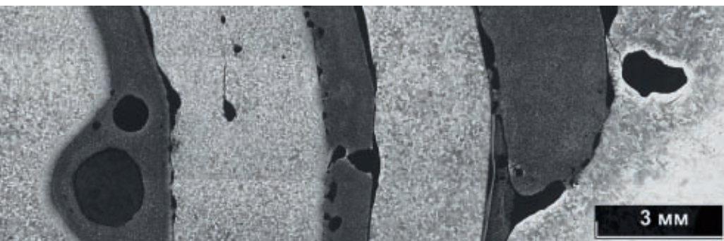
Фото 6. Собранная из чередующихся слоев стали и чугуна композиция (парега)
