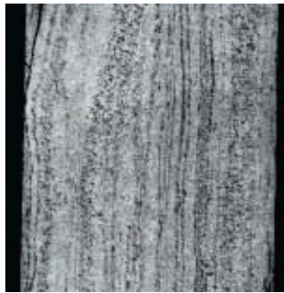
Фото 8. Дальнейшая вытяжка поковки в полосу при температурековки 1100-1000°C не только уменьшает средний поперечный размер слоёв, но и выравнивает их толщину
