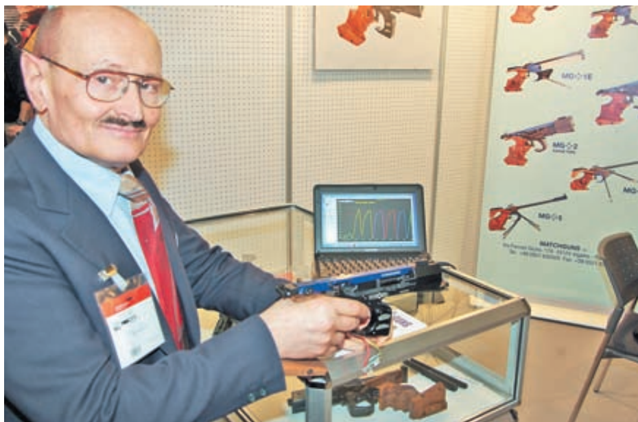
На стенде Match Guns представлен прототип очень интересного прибора, показывающего на экране ноутбука характер обработки спуска
