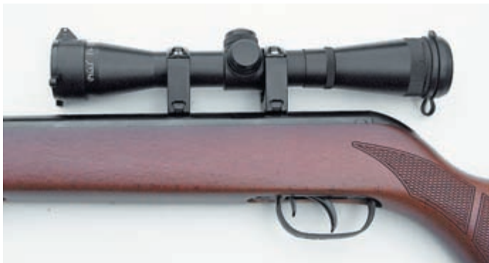
Установка оптического прицела на высоких кольцах в пазы воздушного цилиндра
