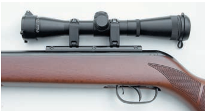
Установка прицела с теми же кольцами на дополнительную планку. Она может привести (но не обязательно приведет) к слишком высокому положению головы при стрельбе
