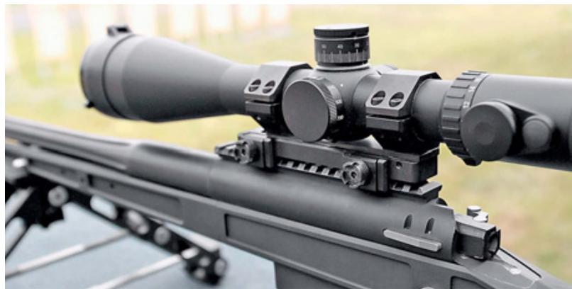
*В Нижнем Тагиле на винтовку ORSIS T-5000 был установлен отечественный оптический прицел DH 5-20x56 (производство московской фирмы «Дедал-НВ») с уникальной функцией контроля завала оружия – прицельная марка откалибрована на значение в 1 градус, при превышении которого она начинает мерцать, сигнализируя стрелку о необходимости выровнять оружие*
