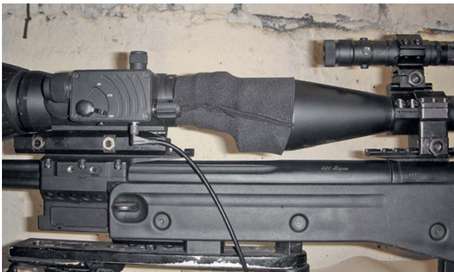
Первоначально подсветка была смонтирована сверху, а прицел установлен на низких кольцах
