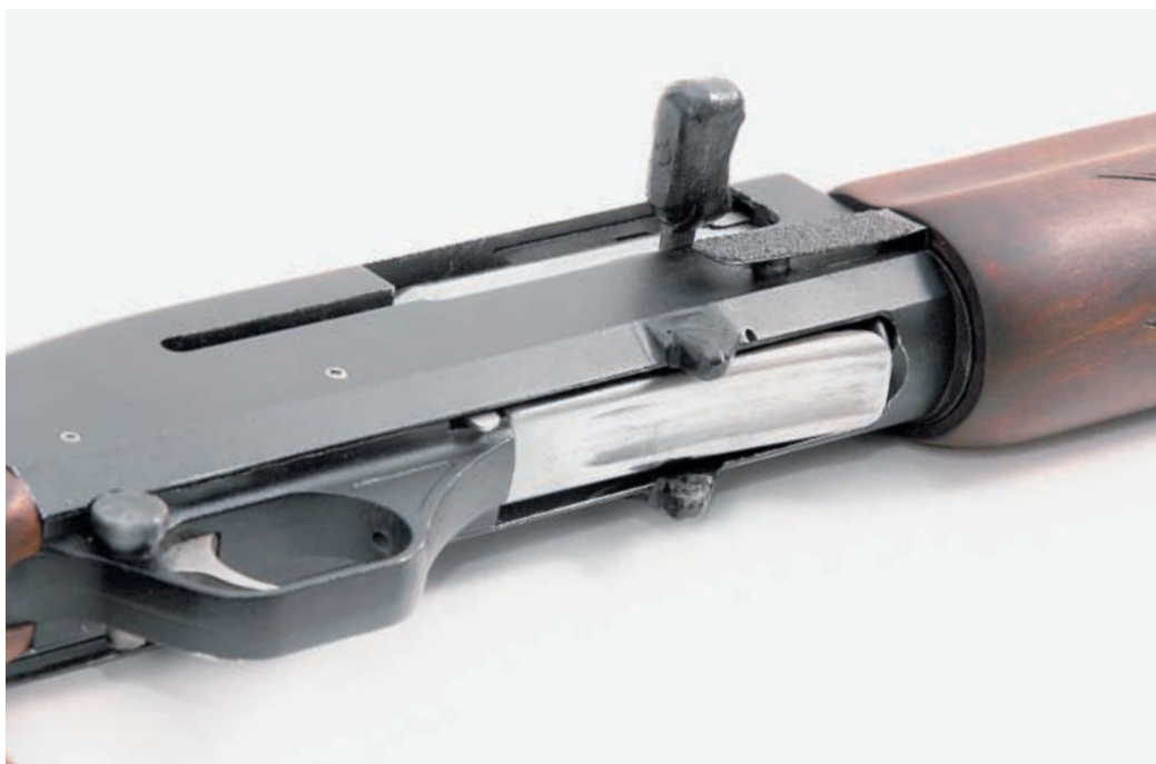
Углубление с нижней стороны лотка для подачи патронов.
