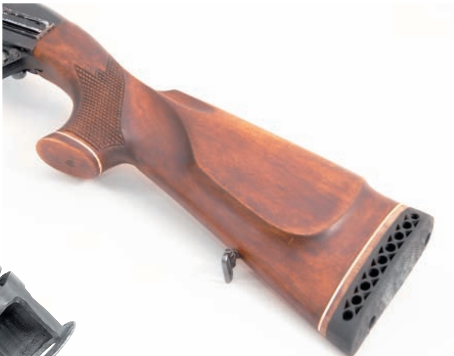
Установлен приклад, имеющий увеличенный погиб и отвод в сторону
