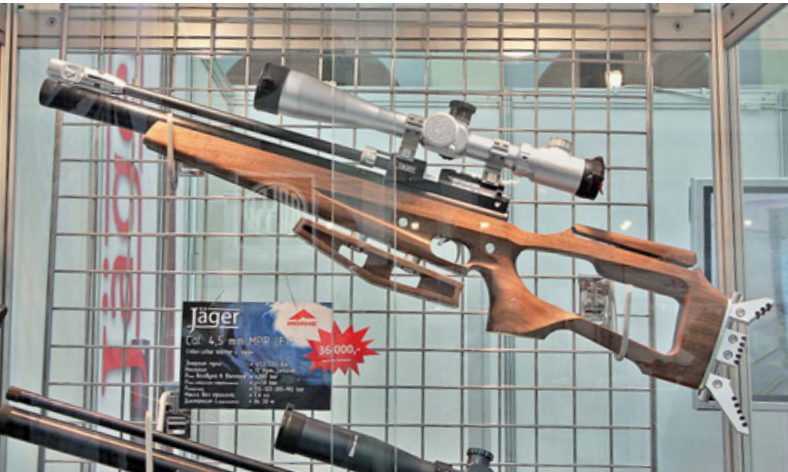
Jager MPR FT на стенде КСПЗ. Обратите внимание на затылок приклада и «гриб» под ложей
