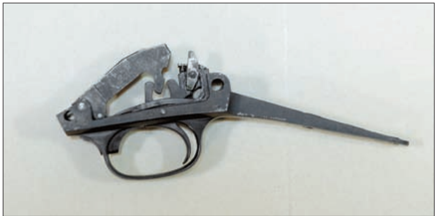
Ударно-спусковой механизм курок взведён
