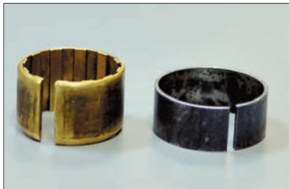
Детали тормозной муфты: тормозное кольцо (слева) и пружинное кольцо
