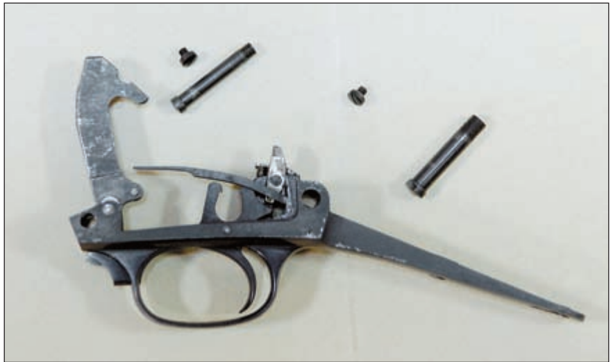
Ударно-спусковой механизм с винтами крепления. Курок спущен
