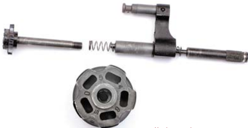
На фотографии хорошо видно устройство камор барабана
