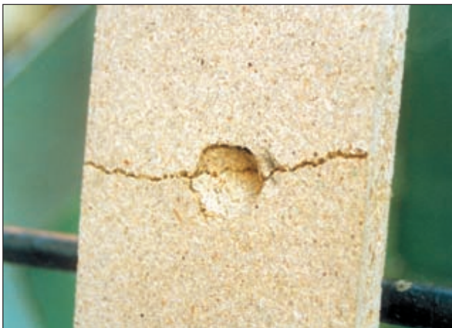
Результаты выстрела из «Осы» в плиту ДСП лицевая (слева) и обратная сторона. Стрельба производилась с дистанции 2 м по плите толщиной 20 мм. Эксперимент наглядно продемонстрировал эффективность «Осы» на коротких дистанциях
