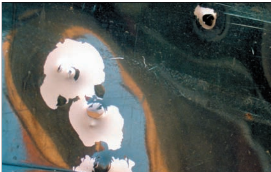
Результаты стрельбы по дверям «Жигулей». Дистанция стрельбы 2–2,5 м. Хотя сквозного пробития и не произошло (пули отскакивали от дверей), однако в 100% случаев пуля, выпущенная из «Осы» не просто оставляет вмятину, а прорывает металл в месте контакта
