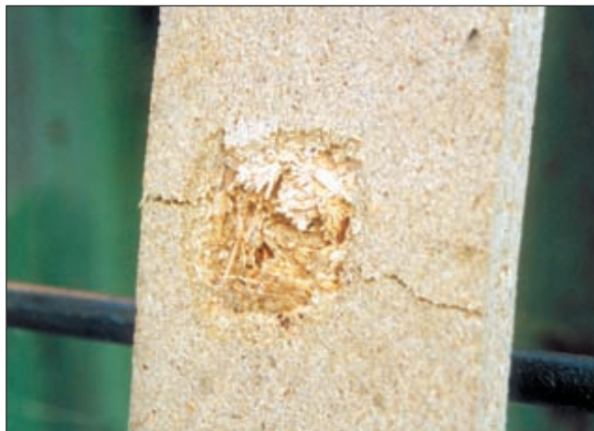
Результаты выстрела из «Осы» в плиту ДСП лицевая (слева) и обратная сторона. Стрельба производилась с дистанции 2 м по плите толщиной 20 мм. Эксперимент наглядно продемонстрировал эффективность «Осы» на коротких дистанциях
