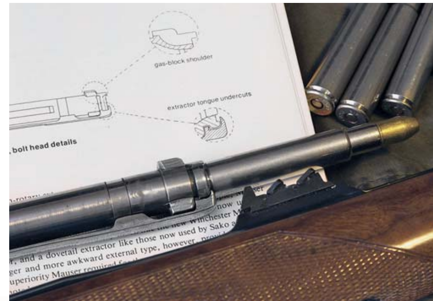
CZ 550 Magnum – это единственная современная винтовка с контролируемой подачей патрона, сохранившая от модели Mauser 98 вырез под «язычок» выбрасывателя, который крепко прижимает выбрасыватель к донцу гильзы
