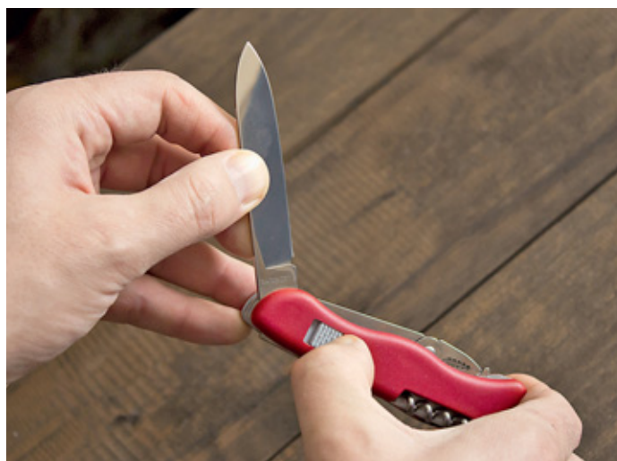
Механизм фиксации клинка в ножах Wenger и Victorinox устроен по-разному. У Wenger для складывания ножа на кнопку фиксации необходимо нажать, у Victorinox – сдвинуть и удерживать в таком положении
