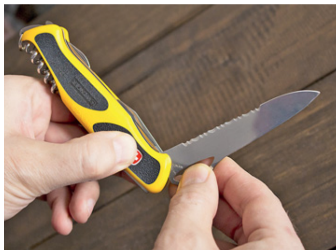
Механизм фиксации клинка в ножах Wenger и Victorinox устроен по-разному. У Wenger для складывания ножа на кнопку фиксации необходимо нажать, у Victorinox – сдвинуть и удерживать в таком положении
