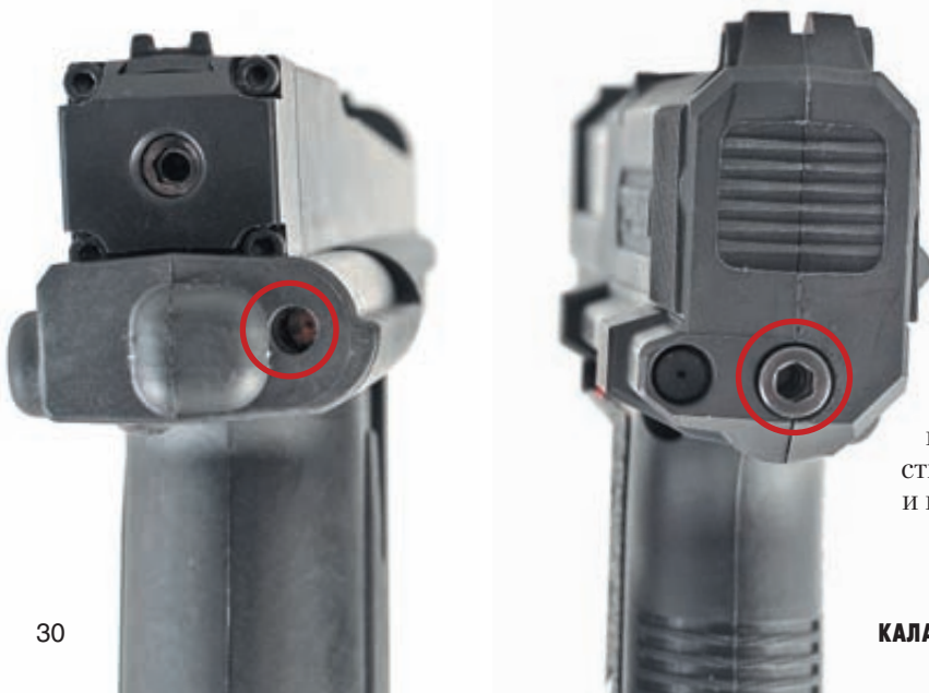
Вид сзади на пистолеты TPX (справа) и T8. На фото отмечены винты настройки начальной скорости вылета шара
