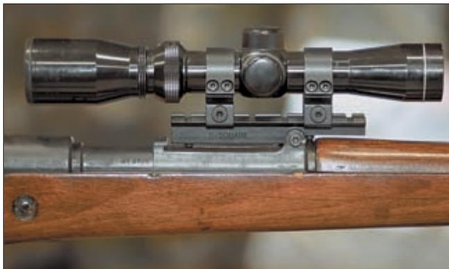
*Монтаж оптики на карабине Маузера образца 1898 г. (КО-*
