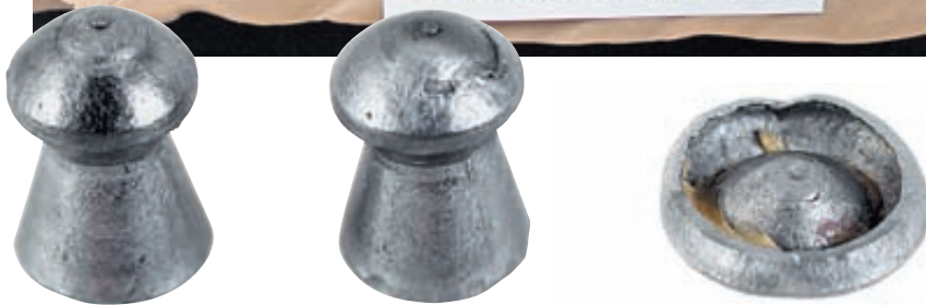
Пуля Baracuda до и после (справа) попадания в пластилиновый блок. Деформация пули практически отсутствует
