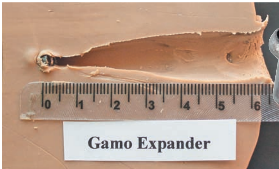
Пуля Gamo Expander до и после (справа) попадания в пластилиновый блок. Отделившиеся фрагменты головной части не показаны
