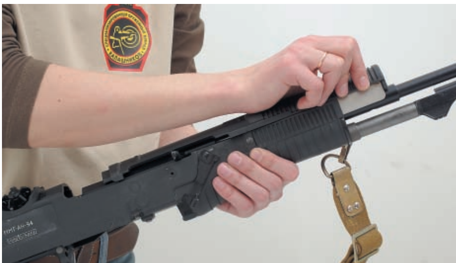
Отделение крышки кожуха производится движением вперёд
