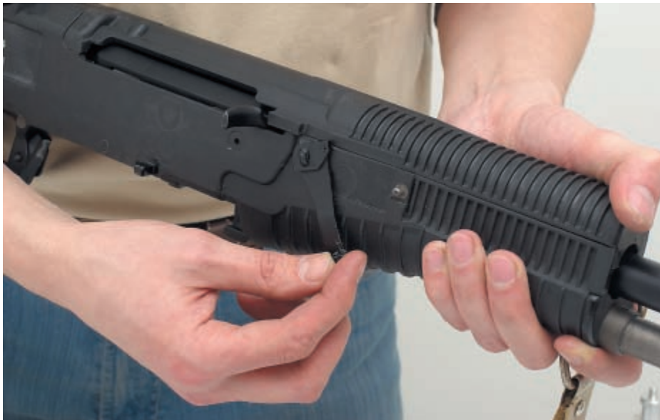
Снятие защёлки крышки кожуха
