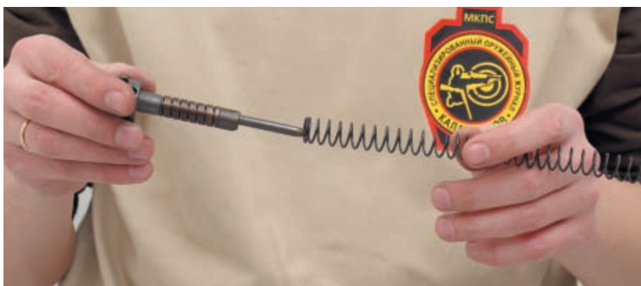
Снятие боевой пружины с буферного механизма
