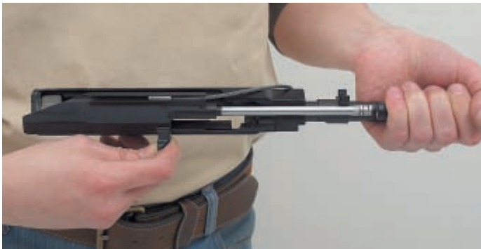
Перемещение затворной рамы вместе с курком в крайнее заднее положение
