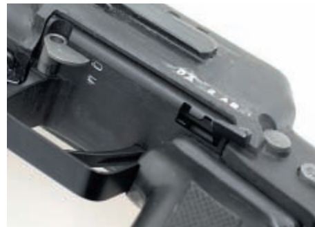
Переводчик режимов огня установлен в положение «АВ», а предохранитель – в положение «О»
