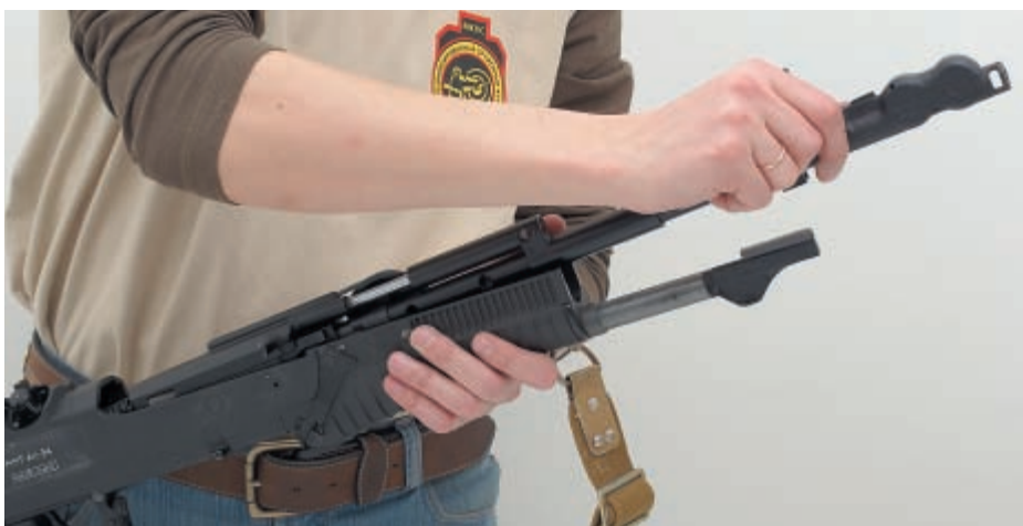
Отделение крышки кожуха производится движением вперёд
