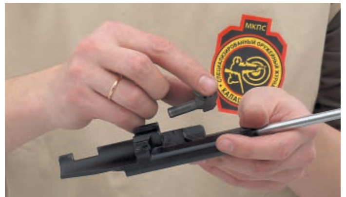
Отделение затвора от затворной рамы
