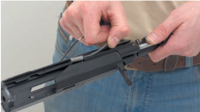
Выдвижение наконечника с тросом из отверстия затворной рамы
