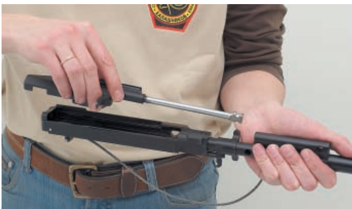
Извлечение затворной рамы с затвором
