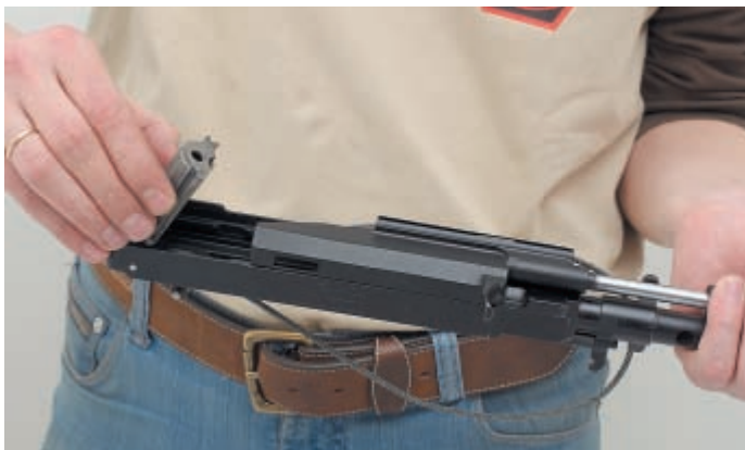
Извлечение курка из ствольной коробки
