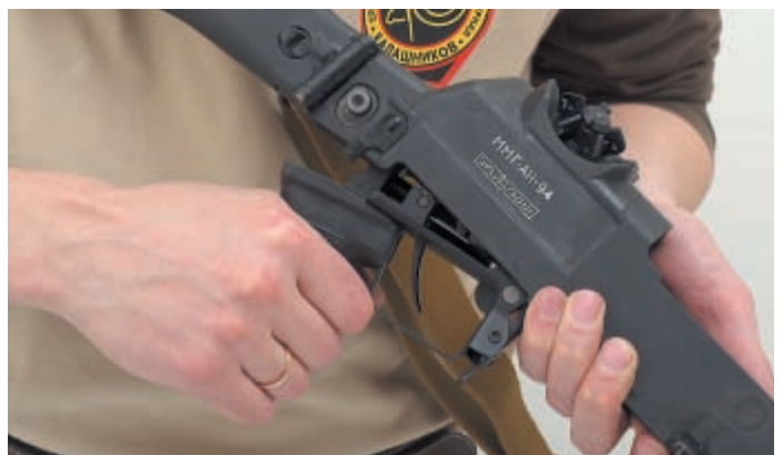
Отделение спускового механизма
