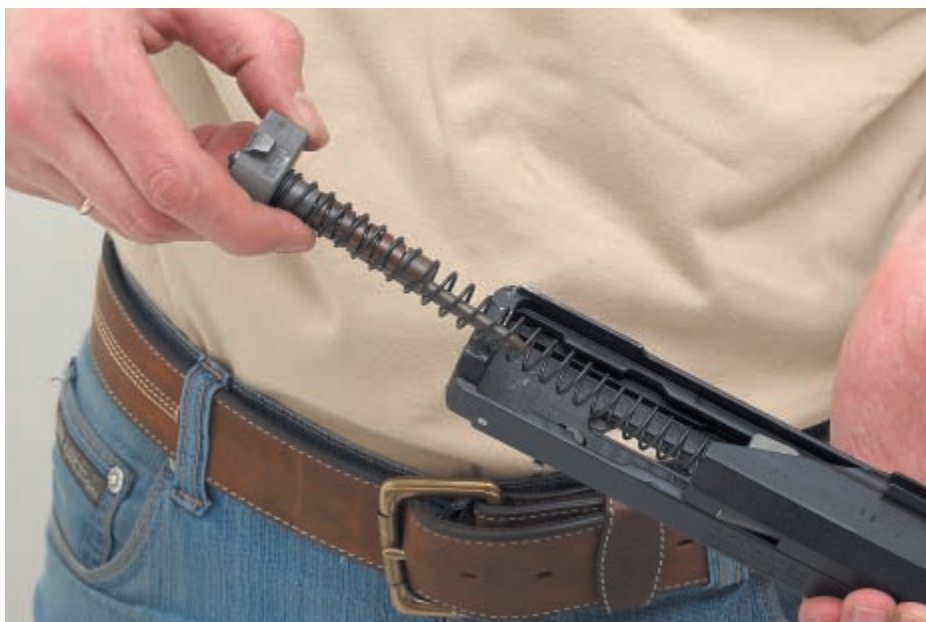
Отделение буферного механизма от ствольной коробки
