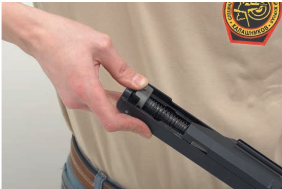
Выведение буферного механизма из зацепления со ствольной коробкой
