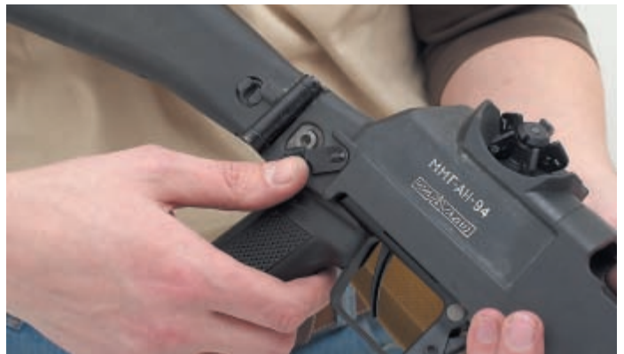
Для отделения спускового механизма нужно утопить выступ фиксатора приклада и повернуть чеку против часовой стрелки на 90°
