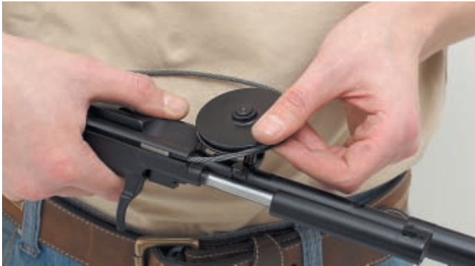
Снятие ролика с цапфы корпуса ролика
