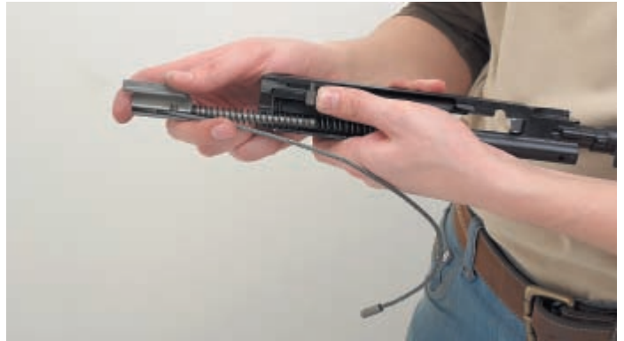
Извлечение выталкивателя с тросом и пружиной из ствольной коробки
