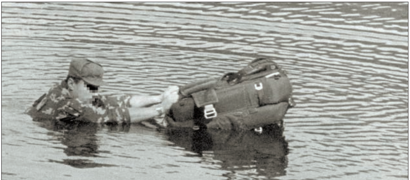
Испытания на плаву. Масса снаряжённого рюкзака 40 кг. Масса офицера 85 кг
