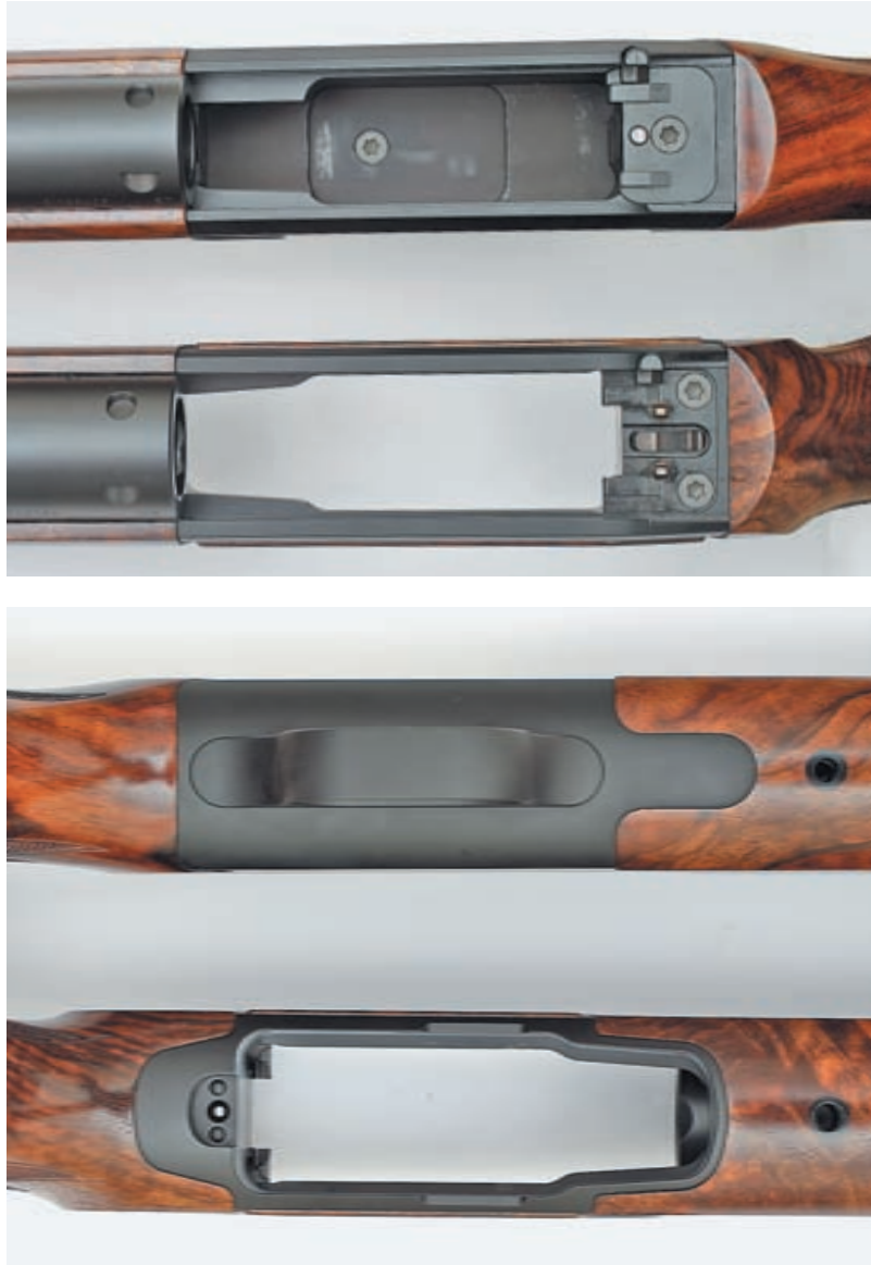
Вид сверху на ствольные коробки двух карабинов явно показывает главное конструктивное отличие – наличие сквозного порта для магазина у R8. На виде снизу хорошо виден толкатель спускового механизма R8, с которым взаимодействует заднее плечо спускового крючка
