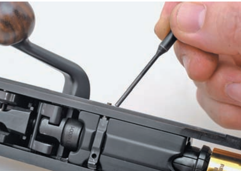
В карабинах обеих систем присоединение затворной рамы к ствольной коробке невозможно при не до конца зафиксированном замыкателе затвора. Выколоткой показан блокирующий элемент
