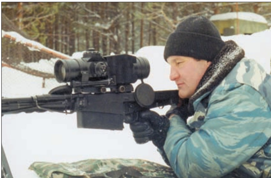
Крупнокалиберная винтовка В-94, находящаяся на вооружении «Кречета», оснащена 13-кратным прицелом с мощной широкоугольной оптикой. Теперь бойцы имеют в своем распоряжении и новый снайперский патрон калибра 12,7х108, оснащённый специальной пулей массой 56 г. Начальная скорость пули 730 м/с
