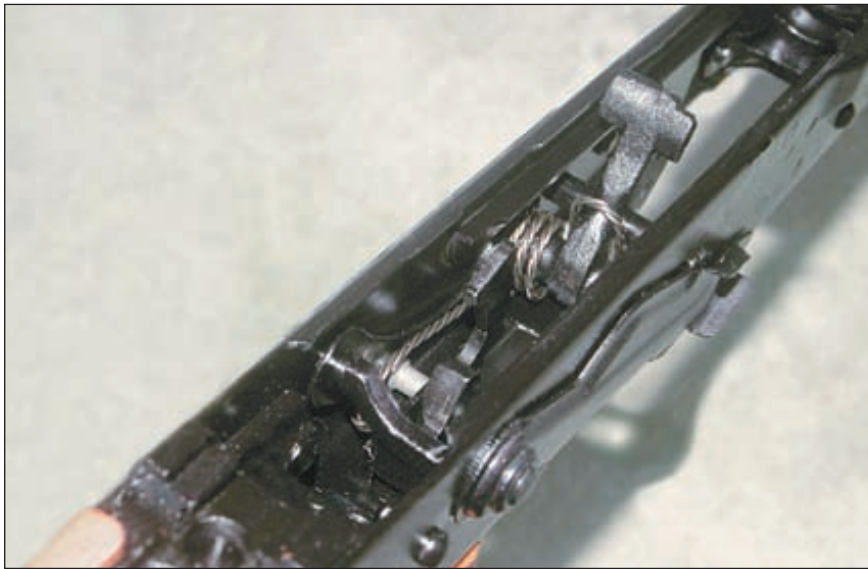
Ударно-спусковой механизм карабина «Вепрь». Курок спущен
