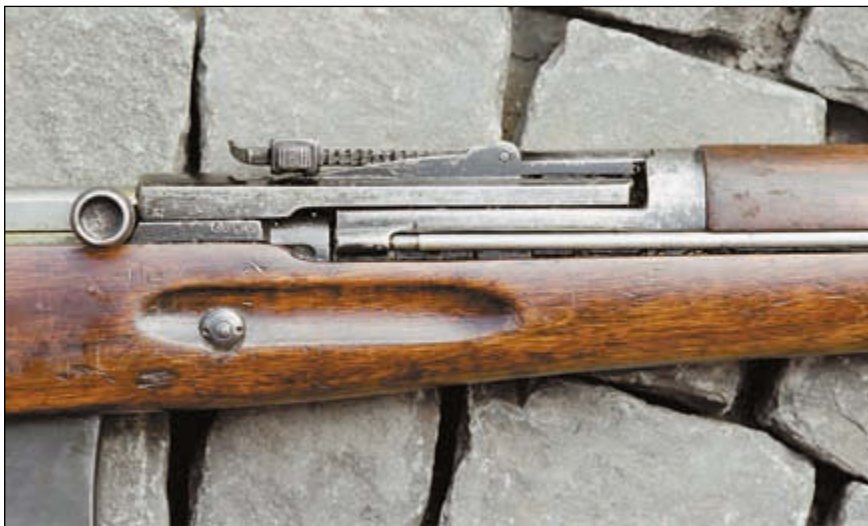
Прицельная колодка АВС-36 насаживалась на казённую часть ствола. Шомпол винтовки располагается с правой стороны ложи
