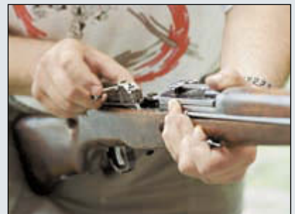
4. Отделить затвор со стеблем затвора и ударником
