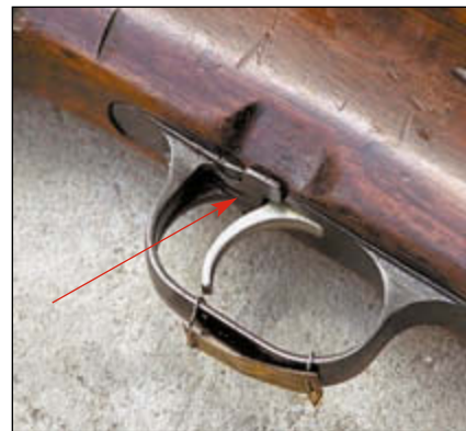
Предохранитель винтовки располагался в задней части спусковой скобы и запирал спусковой крючок (на фото предохранитель включен)
