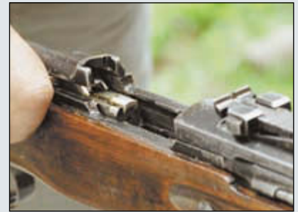
2. Проверить на наличие патрона в патроннике
