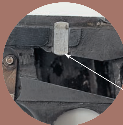
Разобщитель перемещается в рамке по «Т-образному» пазу
