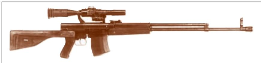
*Опытная снайперская винтовка Симонова. Из-за низкой надёжности работы автоматики доработка винтовки была признана нецелесообразной*
