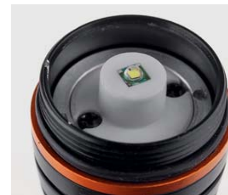
Фонарь FormOptik Focus оснащён светодиодом XP-E последнего поколения (слева). Насечка покрывает большую часть корпуса фонаря
