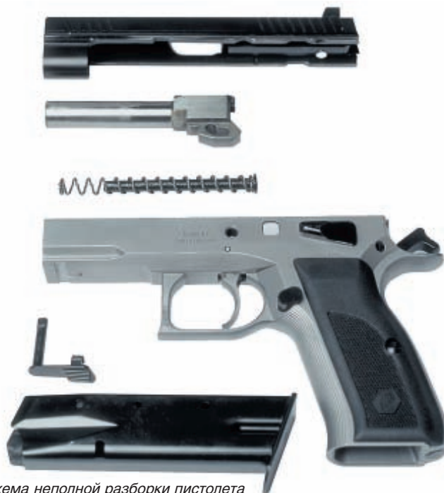
Схема неполной разборки пистолета
