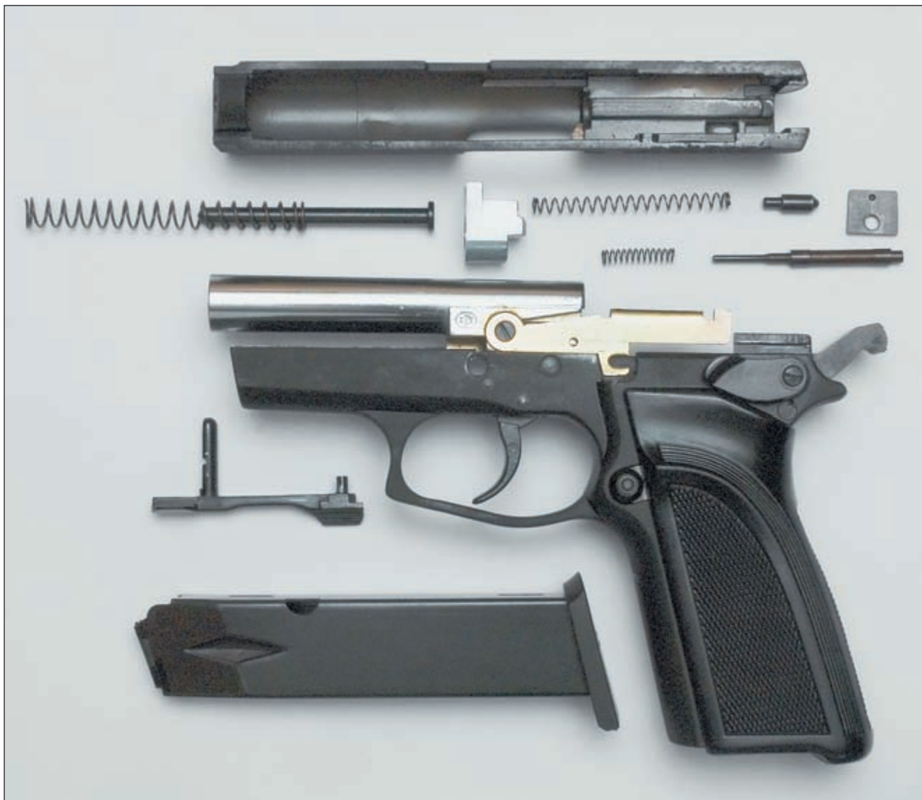
Детали неполной разборки пистолета STEEL
