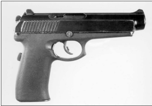
Прототип пистолетов SP-1 и СПС – 9-мм пистолет «Грач» 6П35 конструкции Сердюкова П. И. под патрон РГ 052 (9x21) (ЦНИИТОЧМАШ). Вид справа. Принцип работы автоматики – отдача затвора при коротком ходе ствола
