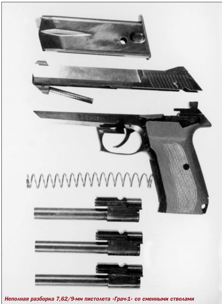
7,62/9-мм пистолет «Грач-1» конструкции Зароченцева А. И («Ижмех») под патроны 9x18 ПМ, 9М (9x18 ПММ) и 7,62x25 ТТ. Принцип работы автоматики: с патроном 9x18 ПМ – отдача свободного затвора; с патронами 7,62x25 ТТ и 9М (9x18 ПММ) – отдача затвора с его торможением пороховыми газами, отводимыми через боковое отверстие в канале ствола
