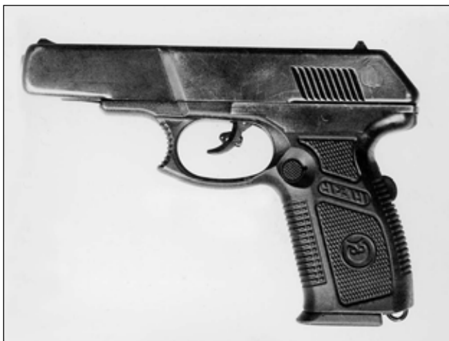
9-мм пистолет 6П35 конструкции Сердюкова П. И. под патрон 7Н21 (9x19). Вид слева. Принцип работы автоматики – отдача затвора при коротком ходе ствола
