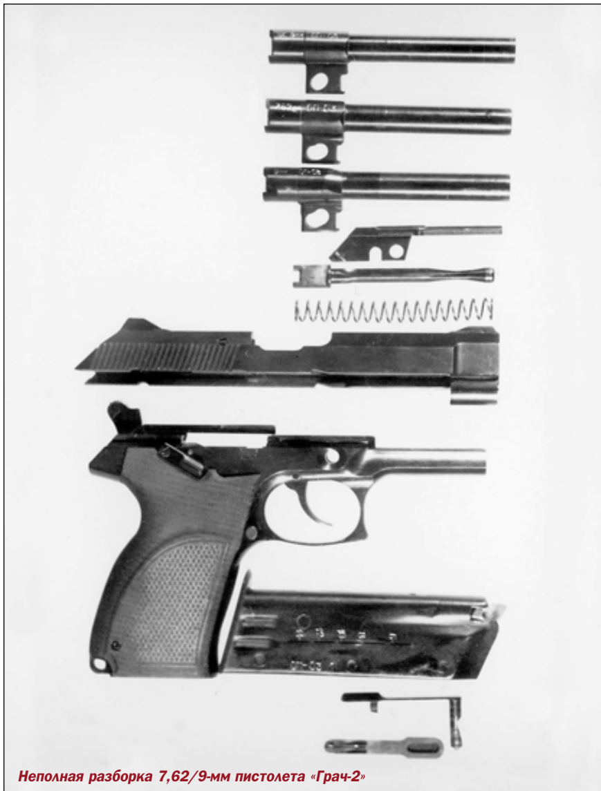
7,62/9-мм пистолет «Грач-2» конструкции Ярыгина В. А. («Ижмех») под патроны 9x18 ПМ, 9М (9x18 ПММ) и 7,62x25 ТТ. Вид справа. Принцип работы автоматики: с патроном 9x18 ПМ – отдача свободного затвора; с патронами 7,62x25 ТТ и 9М (9x18 ПММ) – отдача затвора при коротком ходе ствола
