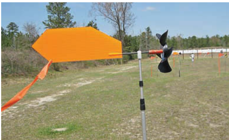
Флаги могут отличаться по конструкции. Лента (хвост) просто просовывается в отверстие
